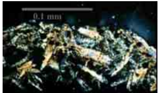
Figura 32. Micrografia in sezione sottile trasversalmente alla superficie della roccia del campione RA4, sx: Nicols //, dx: Nicols \times . Cristalli di gesso ad abito aciculare, bassa birifrazione (colori di interferenza da grigio a bianco) disposti perpendicolarmente alla superficie calcarea.
