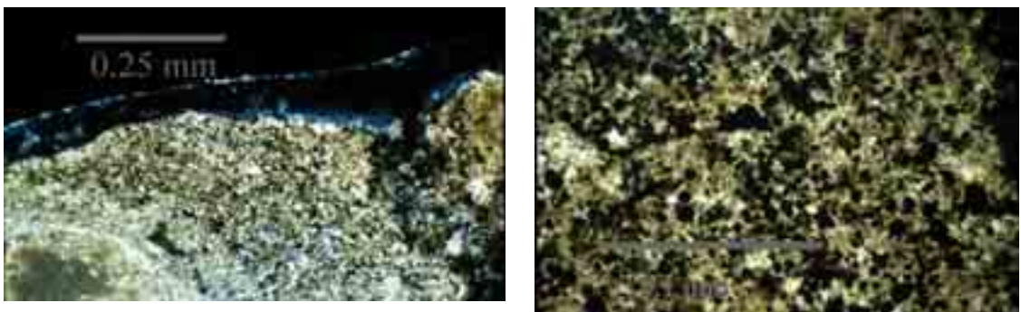
Figura 36 Micrografia in sezione sottile eseguita trasversalmente alla superficie della roccia del campione RA15, sx: Nicols \times , tipico esempio di crosta nera costituita da granulometria microcristallina, inglobante numerose particelle isotrope a contorno subcircolare, da materiale terrigeno e calcite riprecipitata. La concentrazione di particelle carboniose decresce verso l'interno e le parti interne sostituiscono completamente la matrice carboniosa con gesso. Dx: Nicols \parallel , spettro dimensionale delle particelle carboniose che sono comprese nell'intervallo 0.1-50 \mu\text{m} .
