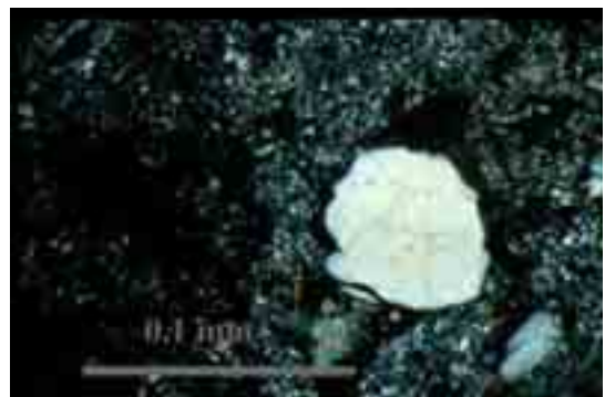
Figura 34. Micrografia in sezione sottile eseguita trasversalmente alla superficie della roccia del campione RA11, sx: Nicols //, dx: Nicols \times . Roccia carbonatica. Al centro della foto è visibile un cristallo di quarzo inglobato nella matrice.
