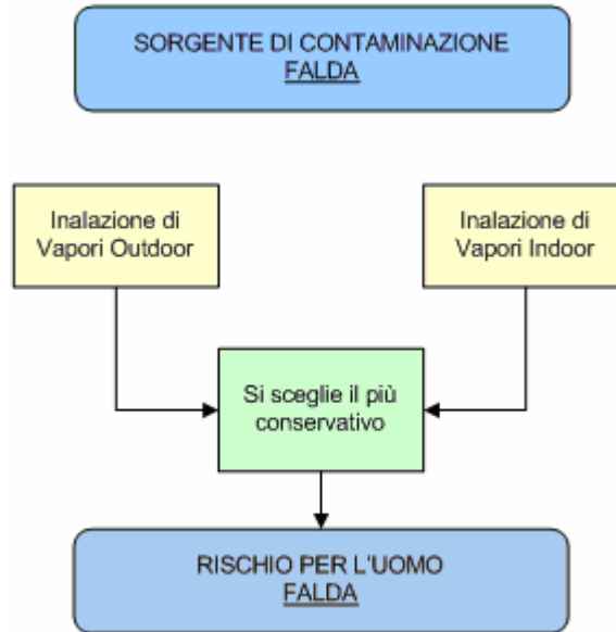
Figura 4.4 – Criterio di calcolo del rischio individuale dovuto a più vie di esposizione per la falda
