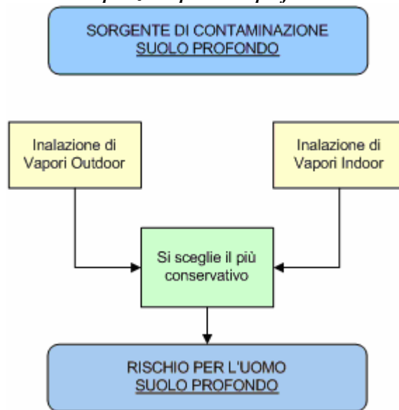
Figura 4.3 – Criterio di calcolo del rischio individuale dovuto a più vie di esposizione per suolo profondo
