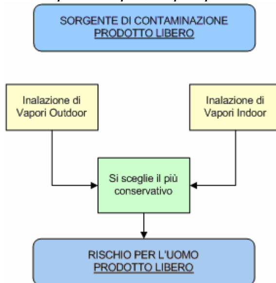
Figura 4.5 – Criterio di calcolo del rischio individuale dovuto a più vie di esposizione per il prodotto libero
