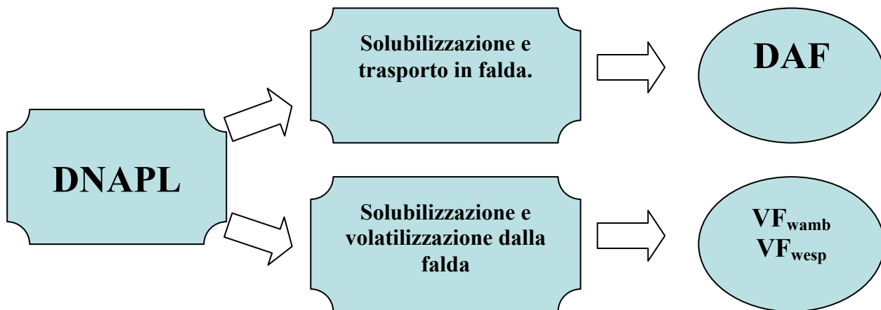
Fig.P.4: trasporto di contaminanti da prodotto libero denso in zona satura (DNAPL)
