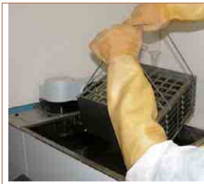
Figura 4.5: la rastrelliera contenente 6 griglie, ciascuna delle quali può supportare 7 \times 7 = 49 lastrine
