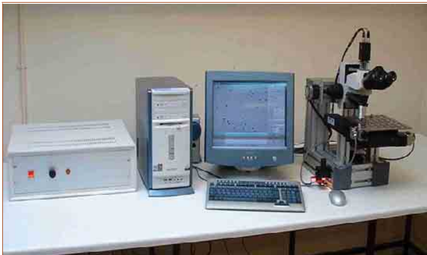
Figura 4.3): il sistema TASLIMAGE disponibile presso il laboratorio di “Rivelatori di tracce nucleari e dosimetria occupazionale” in APAT
