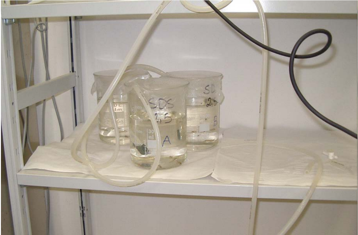
Figura 5 – Test definitivo di tossicità acuta (48 h) con il tossico SDS. Si possono notare i contenitori con concentrazione 2.5 mg/L di SDS.
