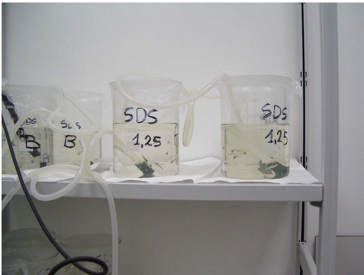
Figura 4 – Test preliminare di tossicità acuta (48 h) con il tossico SDS. A sinistra ci sono i contenitori con i bianchi (B), mentre a destra ci sono i contenitori con concentrazione 1.25 mg/L di SDS.
