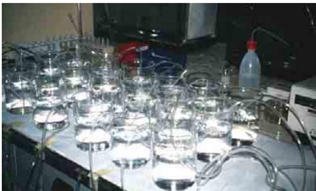
Fig. 13. Esempio di predisposizione di un test di tossicità acuta con stadi larvali di branzino.
