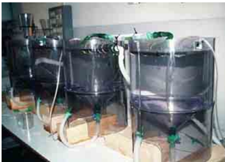
Fig.3 Messa a punto di un apparato per l'incubazione e la schiusa delle uova e il mantenimento delle larve
