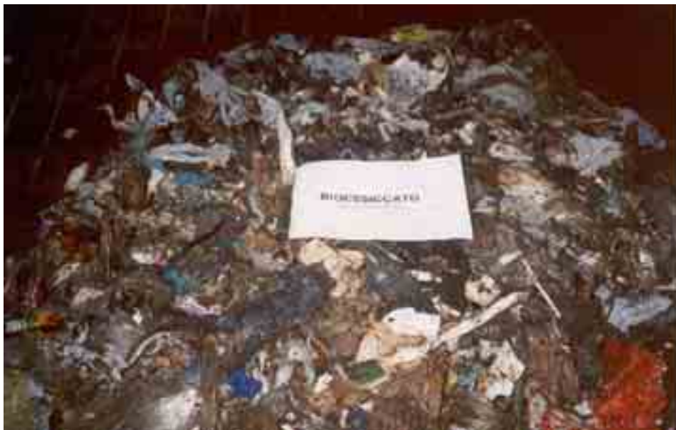
Fig. 2.18: campione di materiale bioessiccato non vagliato fine processo per prova triassiale
