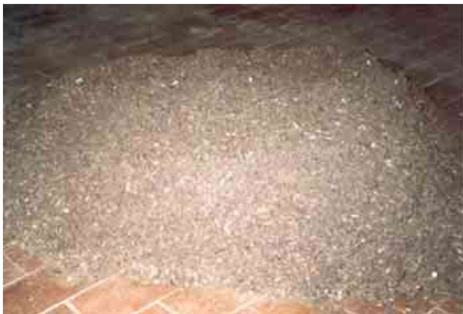
Fig.2.17 - campione di materiale biostabilizzato maturo per prova triassiale.
