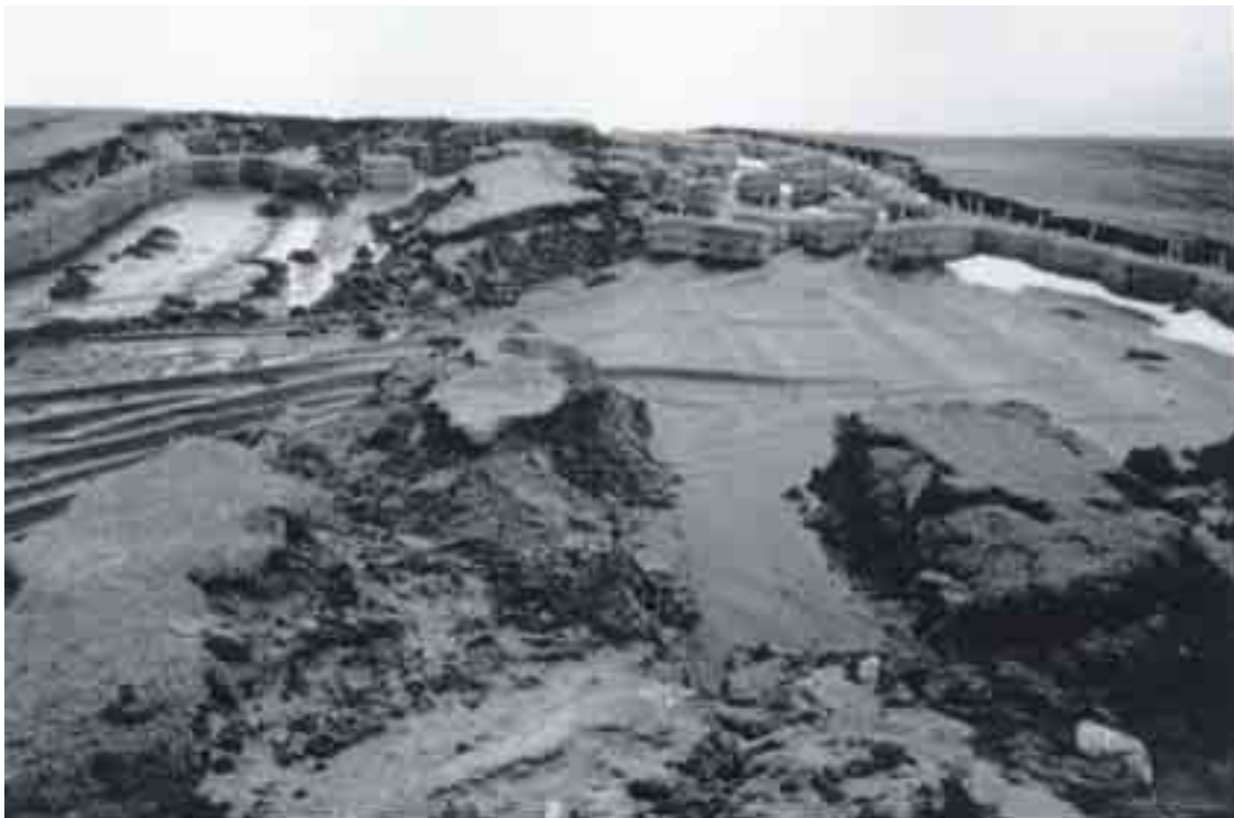
Fig. 3.4 - Foto aerea: esempio di deformazioni superficiali nella discarica - stadio avanzato
