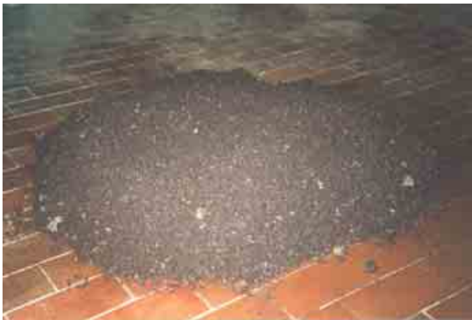
Fig.2.16 - campione di materiale biostabilizzato fresco per prova triassiale.
