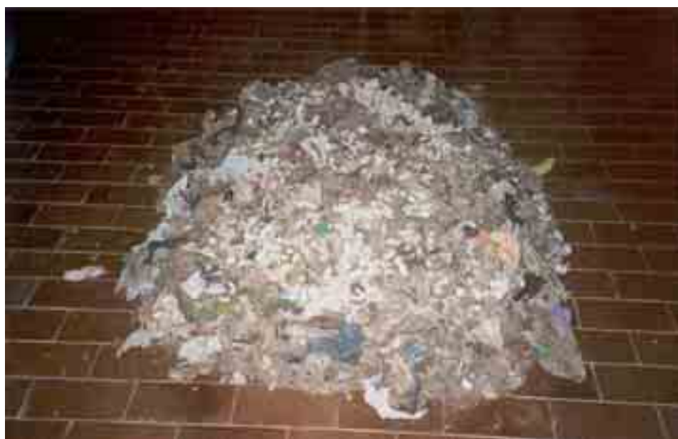
Fig. 2.19: campione di materiale bioessiccato sottovaglio fine processo per prova triassiale.
