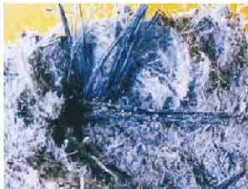
Figura 1- Macrofoto di una lastra in cemento amianto; le fibre di colore azzurro e biancastre-argentee indicano rispettivamente il contenuto fibroso tipo crocidolite e crisotilo.
