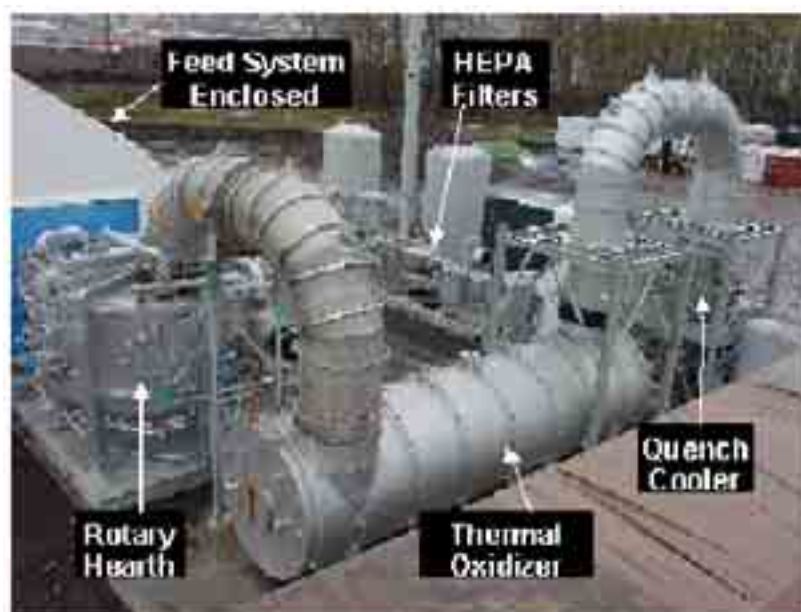
Figura 1- Sistema di conversione termochimica della potenzialità di 10ton/giorno
