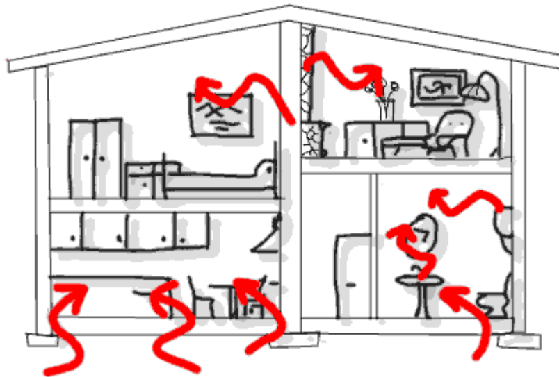
Figura 4.1 Vie d'accesso preferenziali del Radon
