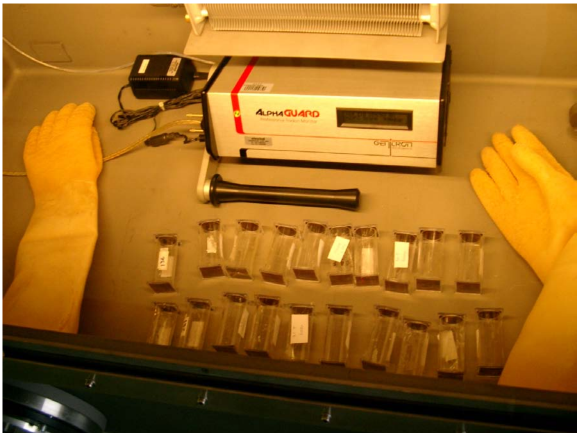
Figura 6.7 Dosimetri all’interno della camera Radon durante un’esposizione; sullo sfondo l’AlphaGuard
