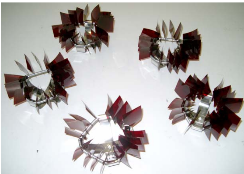
Figura 6.8 Rivelatori fissati sulle molle circolari
