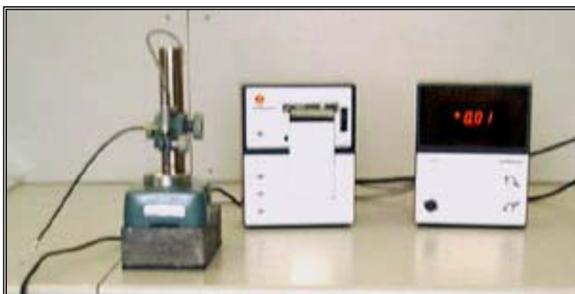
Figura 6.14.2 Comparatore micrometrico
