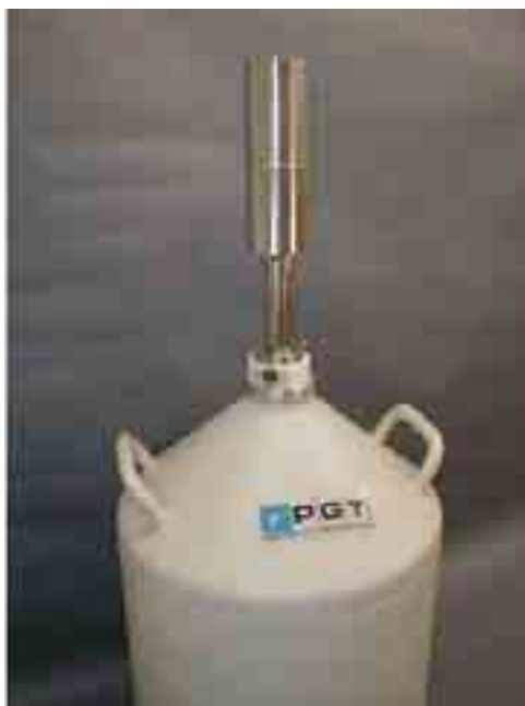
Figura 5-3: Rivelatore al Germanio con sistema di refrigerazione
