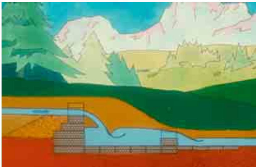
Figura 6.1.19: Schema di una briglia in gabbioni dotata di controbriglia e vasca di dissipazione rivestita con gabbioni di spessore 0.50 m.
