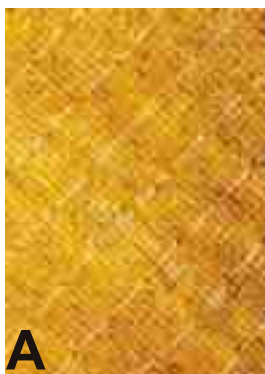
Figura 6.4.31: A) Biostuoia in fibre di cocco: le fibre sono intrappolate tra due retine poliolefiniche che hanno la doppia funzione di impedire la dispersione del cocco e di conferire maggiore resistenza meccanica al geosintetico. Generalmente le retine sono fotodegradabili, in modo da scomparire una volta esauritasi la funzione protettiva della biostuoia. B) Georete in fibre di cocco. Un materiale caratterizzato da una elevata curabilità e da una buona resistenza meccanica. C) Georete in agave, ha una resistenza meccanica superiore rispetto al cocco ma possiede una durabilità inferiore.
