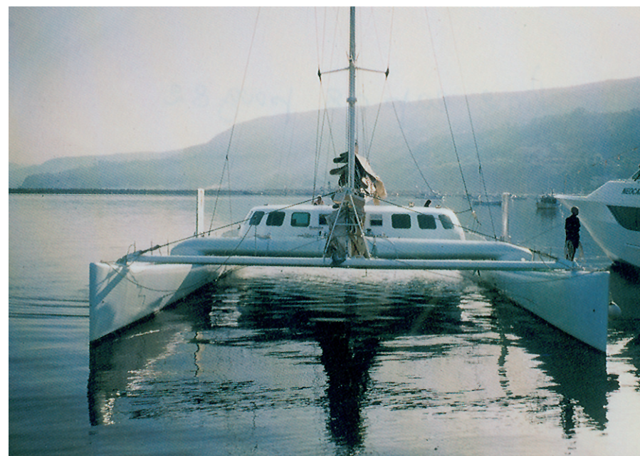
Fig.2 - Il catamarano a vela "Incaurina Marianna" con cui è stato eseguito il rilievo sismico nel settembre 1993. L'imbarcazione si è rivelata particolarmente adatta per lo studio dei TDS in quanto il limitato pescaggio e la buona manovrabilità hanno permesso di realizzare transetti perpendicolari a costa, avvicinandosi a riva anche in prossimità di coste frastagliate o con fondali molto bassi. L'imbarcazione, battente bandiera inglese, è un ex catamarano a vela per regate transoceaniche di dimensioni 28x14m, riattato per lavori di ricerca e charter.
