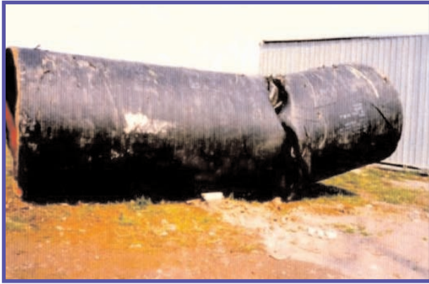
Fig. 1 - La fagliazione superficiale avvenuta nel corso del terremoto in Turchia (Mar di Marmara) del 1999 ha deformato la condotta di due metri di diametro di un acquedotto.
