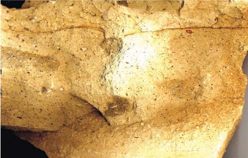
Fig. 16 - Macrofoto di un campione dei tufi grigi di Oricola (OR6). Sono evidenti i lapilli compositi, di colore scuro, che risultano deformati e agglutinati in stato plastico.
