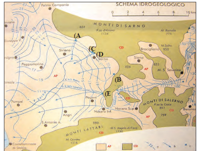
Fig. 50 - Schema Idrogeologico della Piana del Fiume Sarno (da CELICO et alii, 1990). Legenda: AP) complesso alluvionale-piroclastico; CD) Complesso calcareo, calcareo dolomitico e dolomitico; (A) (E) Ubicazione sorgenti. - Hydrogeological map of F. Sarno Plain (from CELICO et alii, 1990). Legend: AP) alluvial-pyroclastic complex; CD) calcareous and calcareous dolomitic complex; (A) (E) Spring ubication.
