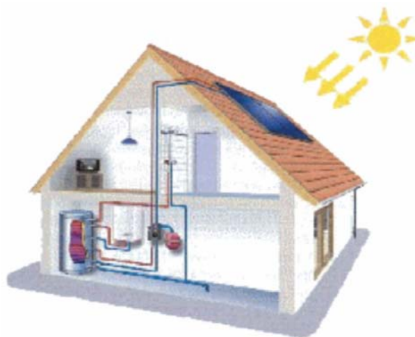
Figura 4: Impianto termosolare. Tutti gli edifici che dispongono di uno spazio soleggiato (tetto inclinato, tetto terrazzato, giardino, ecc.) possono essere dotati di un impianto solare per la produzione di acqua calda sanitaria
