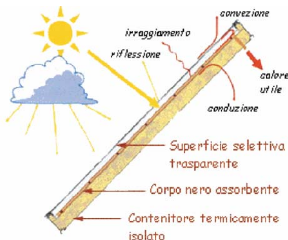
Figura 3: Schema di un collettore piano
