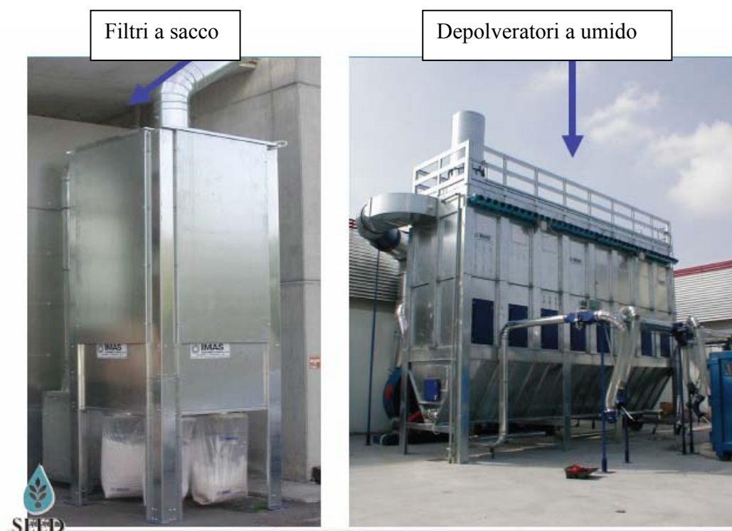
Figura 14.12 - Filtri a sacco e depolveratori a umido (da Trattamenti chimico-fisici dei sedimenti contaminati – lez.16 – Prof. Ing. Rodolfo M. A. - www.campusuniparthenope.it ).
