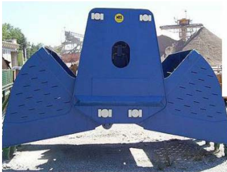
Figura 13.3- Benna convenzionale (da Trattamenti ex-situ: dragaggio - pretrattamenti (cap9) - www.campusuniparthenope.it ).
