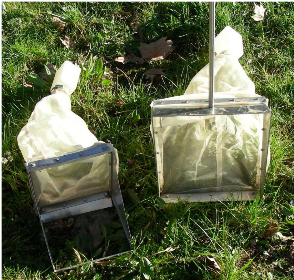
Fig.. 2: immagine dei due strumenti, retino surber a sinistra, retino immanicato a destra. (Buffagni A., CNR-IRSA)
