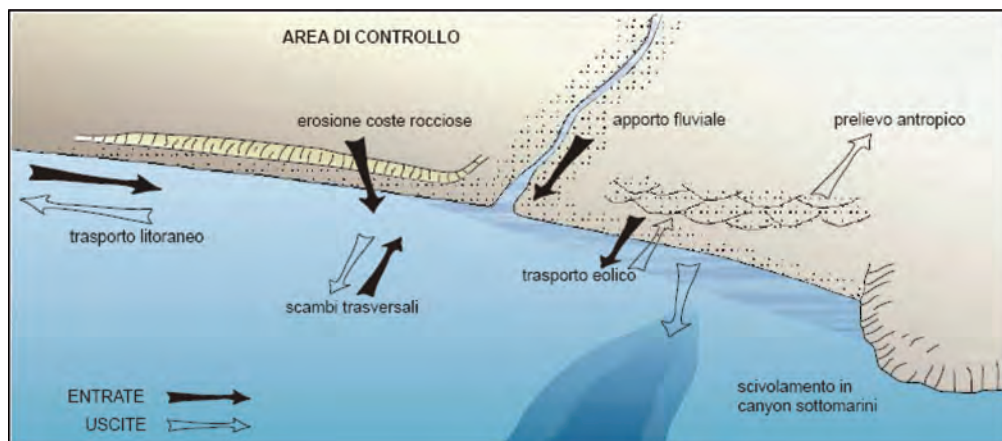
Fig. 4.3: Schematizzazione dei flussi sedimentari all'interno dell'Unità Fisiografica (in APAT, Atlante delle opere di sistemazione costiera, 2007)
