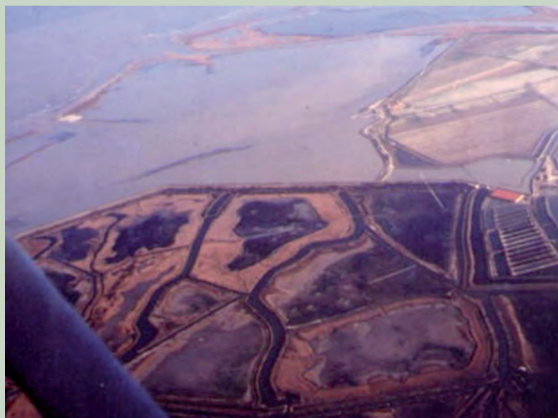
Fig. 16: Vista aerea dei cordoni dunali in forte erosione e delle lagune, in località La Vallona – Po di Levante (RO) prima degli interventi di rivivificazione finalizzati alla miglior circolazione delle acque per le retrostanti valli da pesca mediante dragaggi (Foto Giuliano Sauli)
