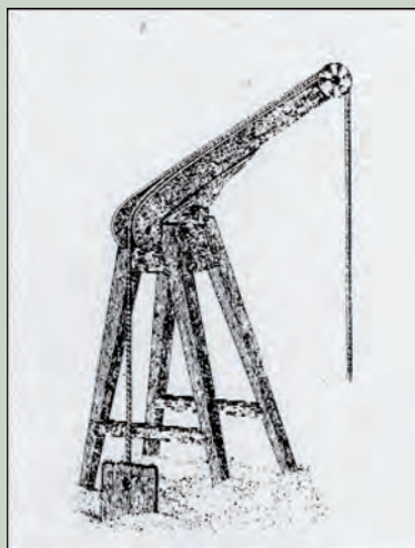
Fig. 3: Leva a gancio (a sx) e dispositivo a carrucola (a dx) per estrarre le tavole delle palizzate sepolte dalla sabbia (da Piccioli, 1923)
