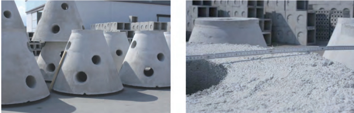
Figg. 11.9 e 11.10: Le campane utilizzate nelle barriere e il dettaglio di una campana in calcestruzzo (Foto Carla Giansante)
