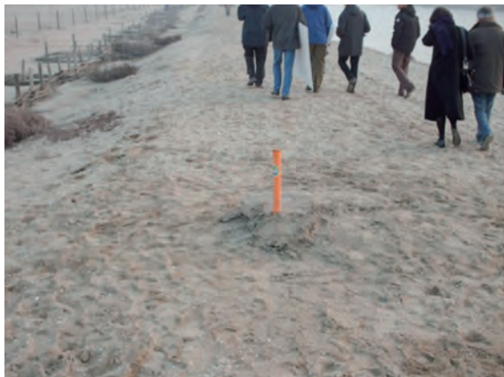
Uno dei piezometri collocati allo scopo di monitorare livello e salinità dell'acqua
