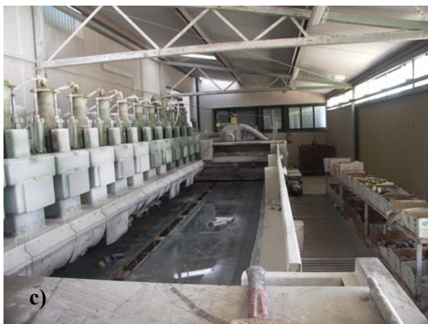
Fig. 11: Fasi della lavorazione del Perlato. Taglio di una faccia di un blocco estratto (a); suddivisione del blocco in lastre mediante sega a multilame diamantate (b); lucidatura delle lastre (c); stoccaggio delle lastre lucidate (d). Foto per gentile concessione di C. Zola
