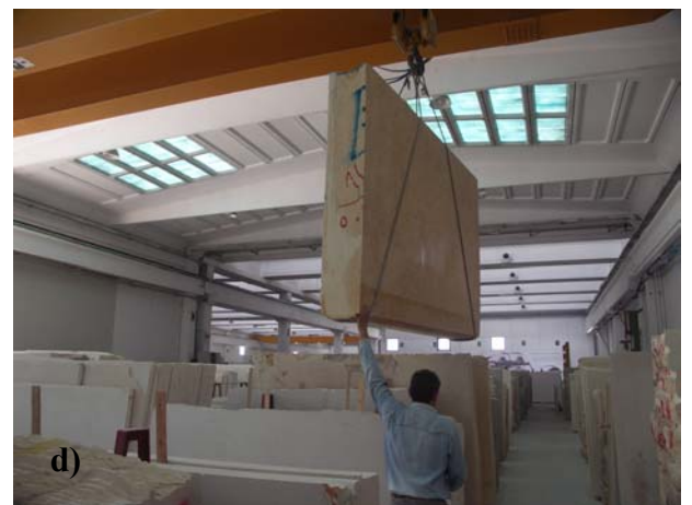
Fig. 11: Fasi della lavorazione del Perlato. Taglio di una faccia di un blocco estratto (a); suddivisione del blocco in lastre mediante sega a multilame diamantate (b); lucidatura delle lastre (c); stoccaggio delle lastre lucidate (d). Foto per gentile concessione di C. Zola
