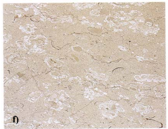
Fig. 8 (a-f): Le diverse varietà estratte attualmente. Perlato Classico (a), Perlato Classico “blu” (b), Mezza perla “chiara” (c), Mezza perla “scura” (d), Perlatino (e), Nocciolato (f) ( Consorzio Valorizzazione Perlato Coreno, 2005 )
