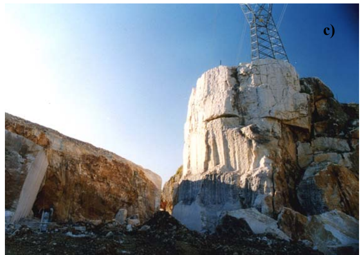
Fig. 10: Tecniche di cavatura del Perlato. Fronte estrattivo predisposto per una “volata” con esplosivo (a); taglio di un fronte a mezzo di filo diamantato (b); tecniche estrattive dell’esplosivo (a destra) e del filo diamantato (a sinistra) nella stessa cava (c). Foto per gentile concessione di C. Longo
