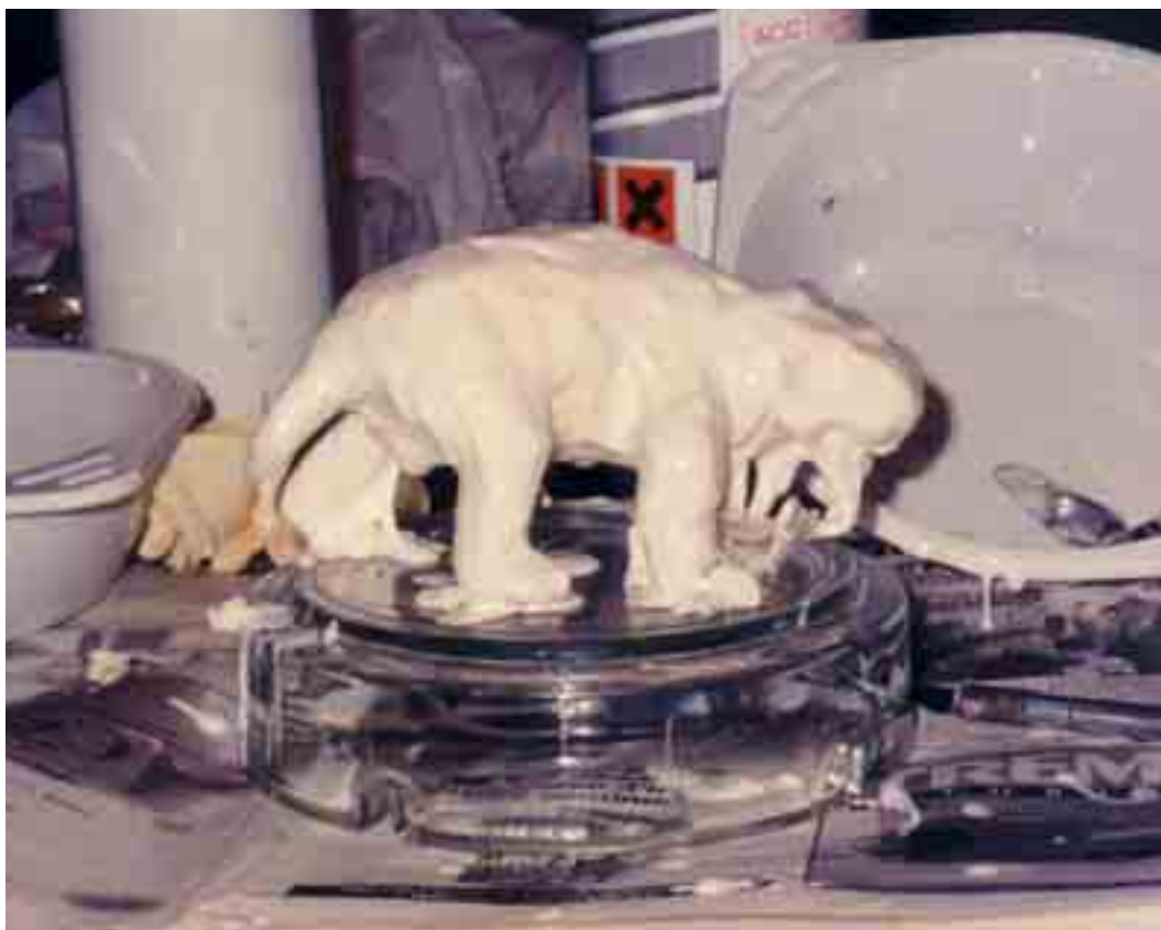
Fig. 55 – Il prototipo in gesso ricoperto di elastomero siliconico liquido senza agente tixotropizzante.
