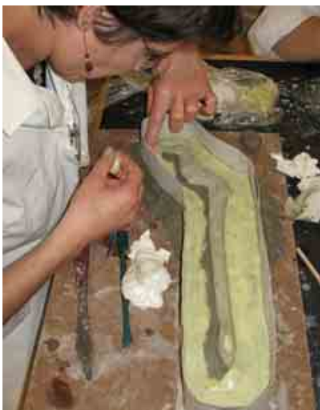
Fig. 69 – L'elastomero siliconico viene spalmato a mano sul propulsore.
