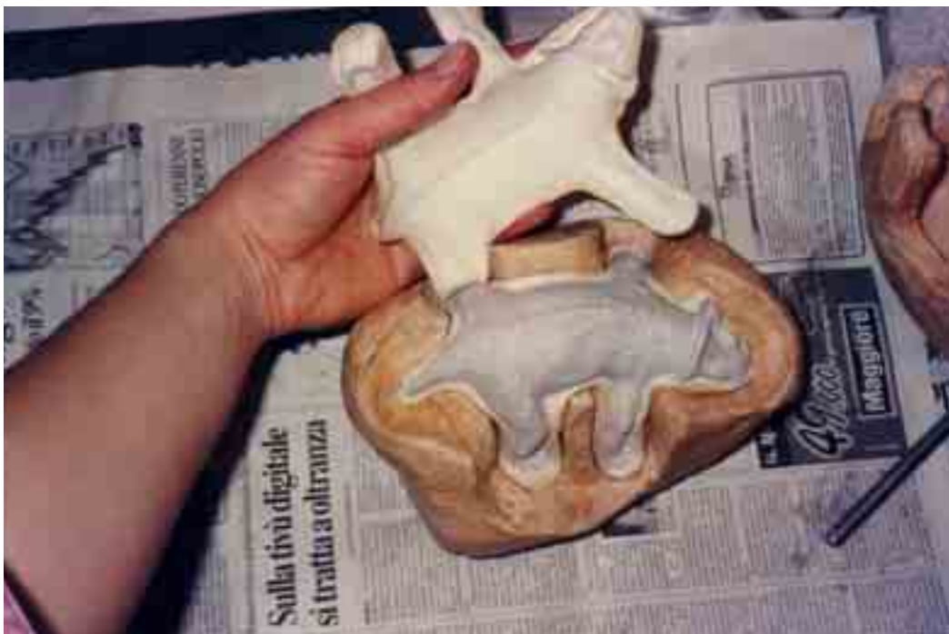
Fig. 66 – Il positivo viene sformato.
