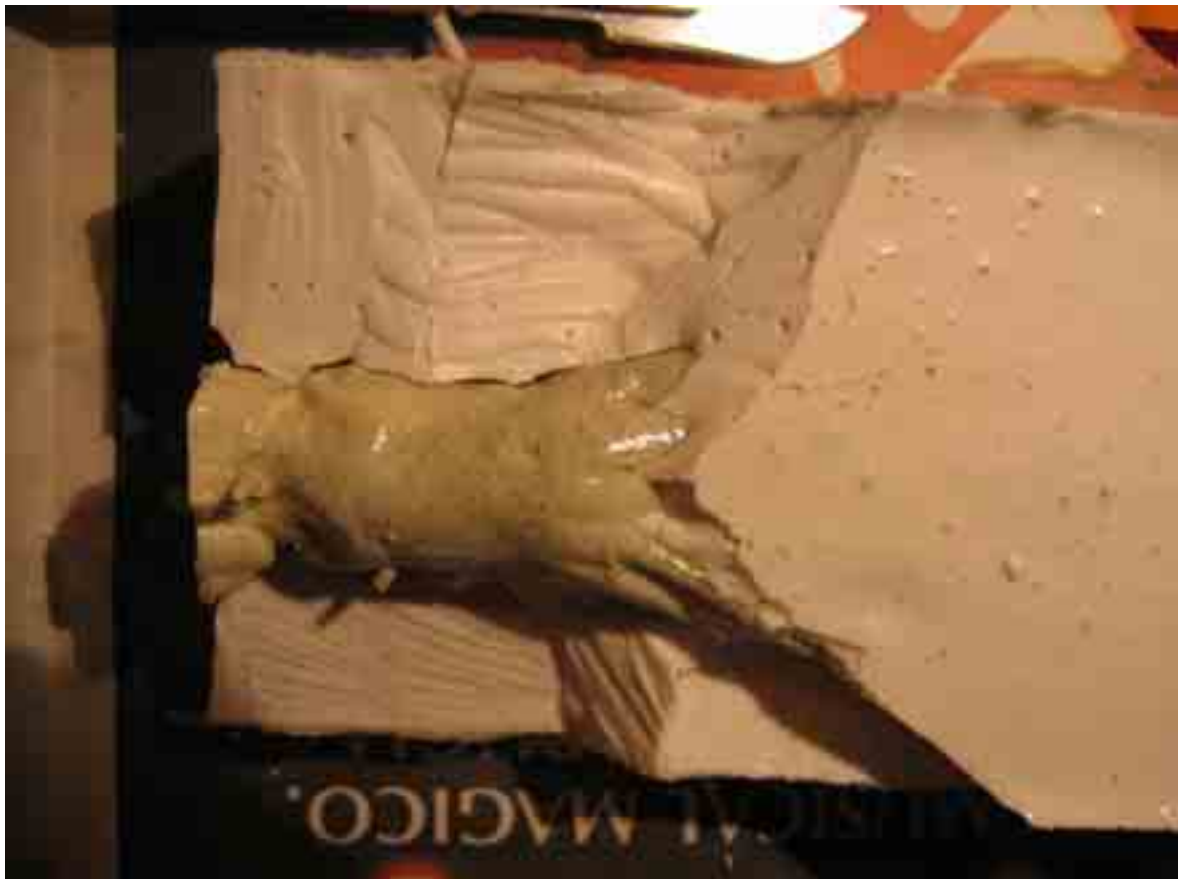
Fig. 77 – La gomma siliconica viene rimossa pezzetto per pezzetto con l'ausilio di un bisturi.
