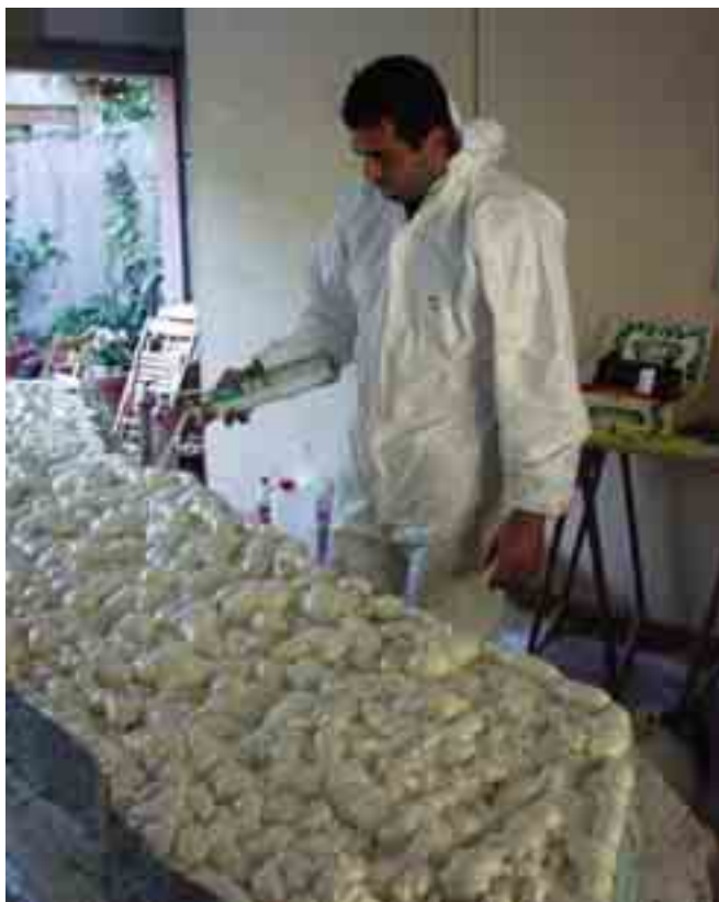
Fig. 3 – Riempimento di un calco con resina poliuretanica espansa monocomponente.
