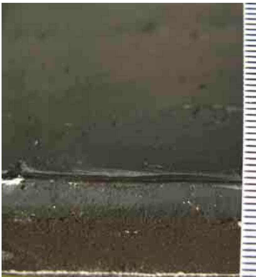
Fig. 91 – Il gesso e la resina, inizialmente a contatto, con il tempo si sono staccati lasciando uno spazio di circa un millimetro.
