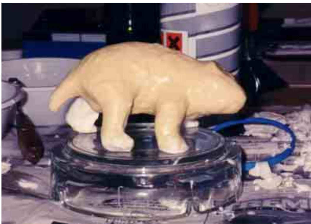
Fig. 56 – Il prototipo ricoperto con elastomero siliconico in pasta per uniformare lo spessore di elastomero e per eliminare i sottosquadri.
