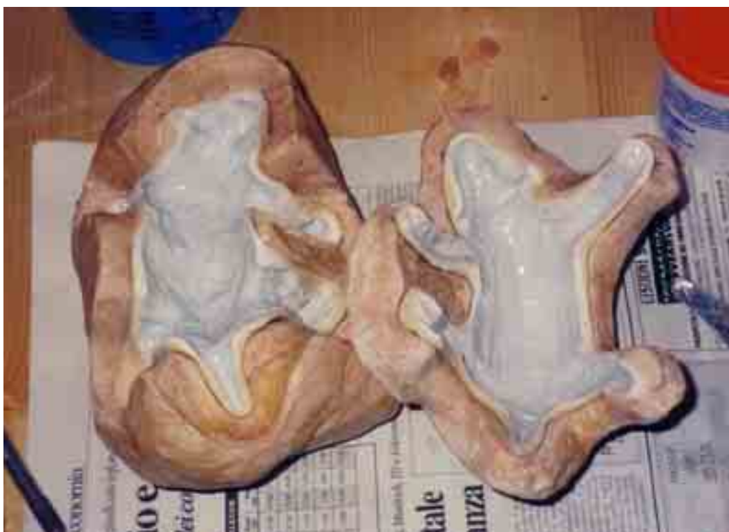
Fig. 64 – Posizionate le due parti del negativo all'interno delle rispettive parti della madreforma, viene spalmata resina epossidica all'interno dei negativi.
