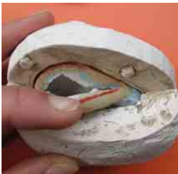
Fig.52 – All'interno del negativo viene colata la resina.
