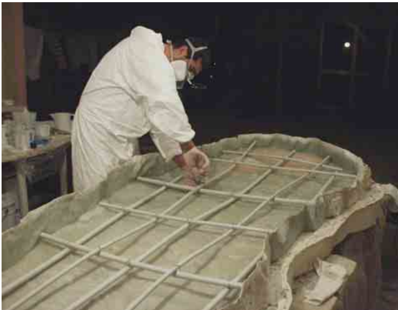
Fig. 40 – Strutture di rinforzo del positivo.
