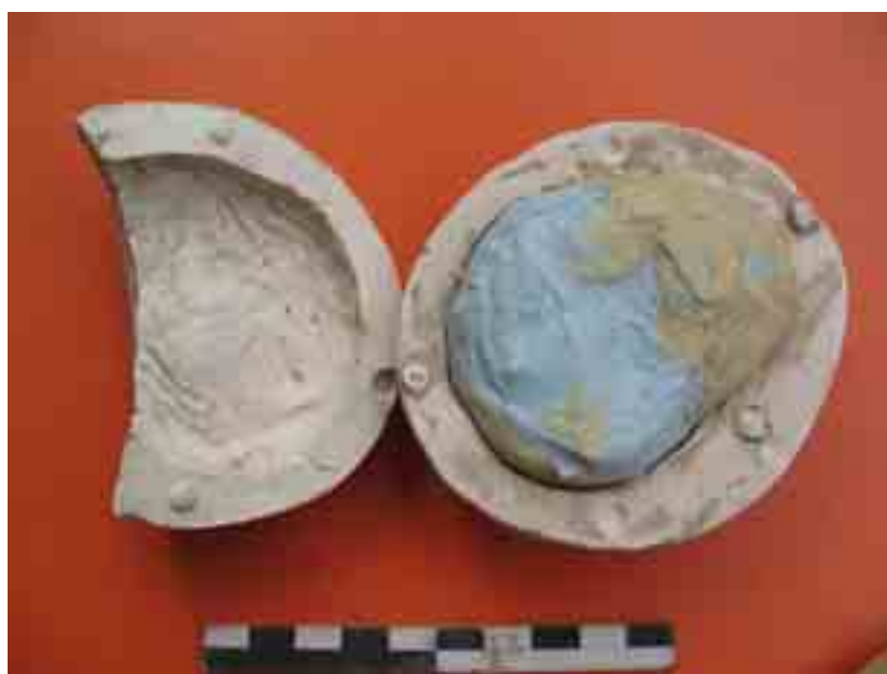
Fig. 50 – Il sistema di perfetto ancoraggio tra le due valve della madreforma.
