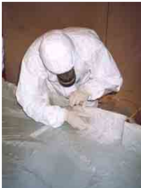
Fig. 39 – Preparazione del bordo in vetroresina.
