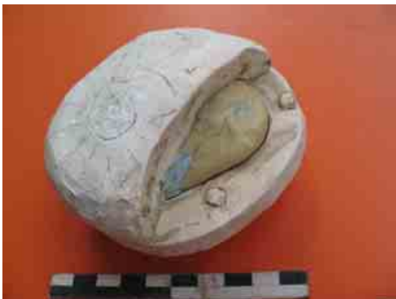
Fig. 49 – La seconda metà della madreforma è stata modellata in modo da lasciare libero il bordo di rinforzo della gomma.
