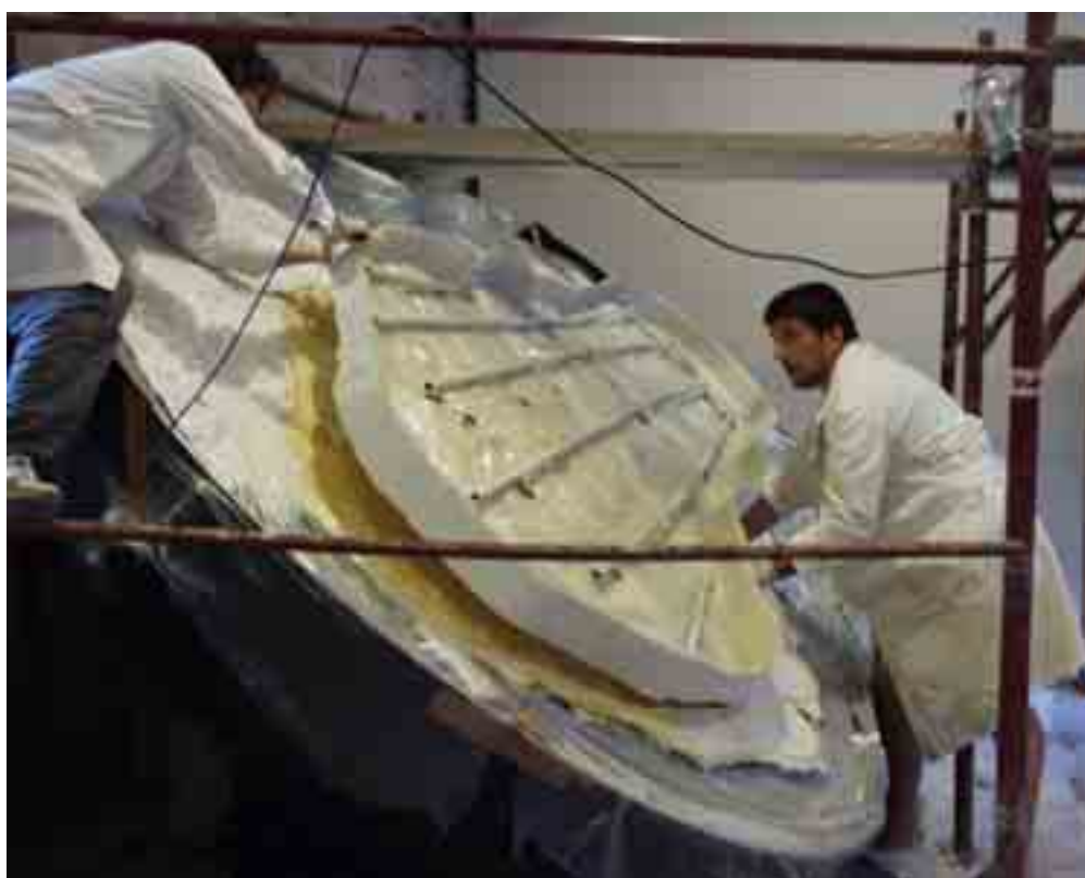
Fig. 29 – La madreforma viene sollevata e tolta dal negativo.
