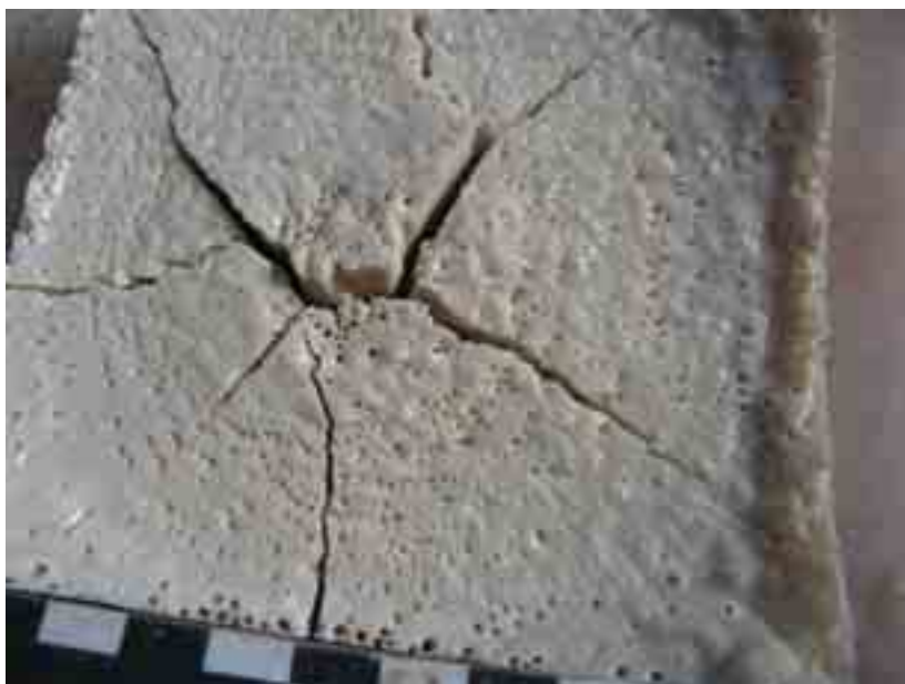
Fig. 2 – Effetti del surriscaldamento della resina poliestere durante la polimerizzazione.
