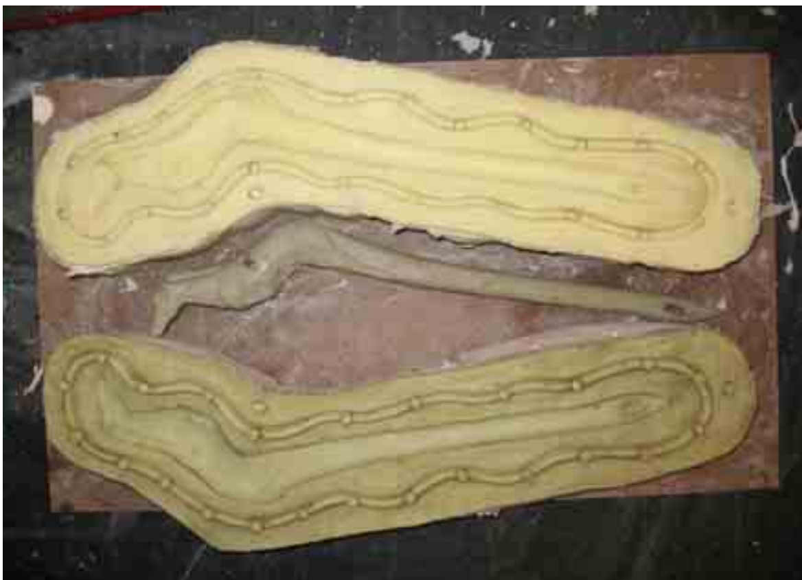
Fig 75 – Il propulsore appena sformato e le due parti della madreforma e del negativo.
