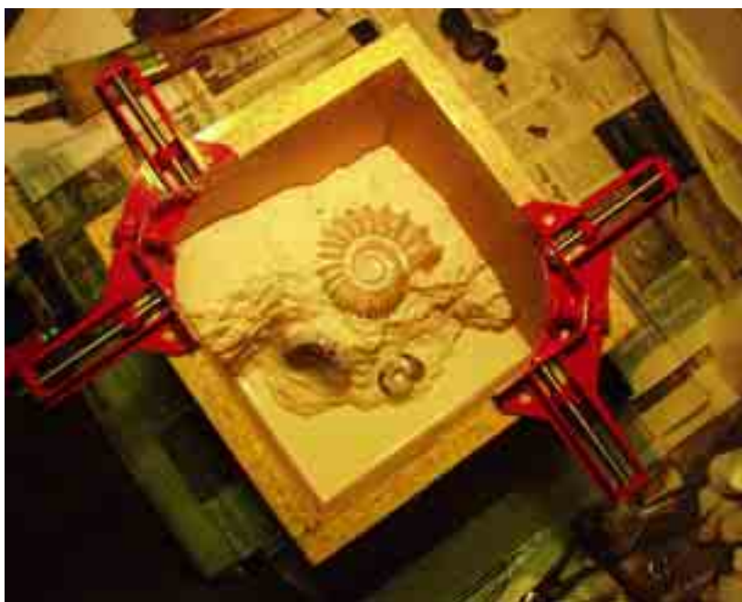
Fig. 8 – Struttura di contenimento per il silicone realizzata con una struttura semimobile di compensato.
