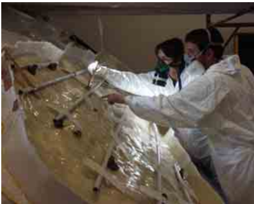
Fig. 28 – La madreforma viene rinforzata internamente.
