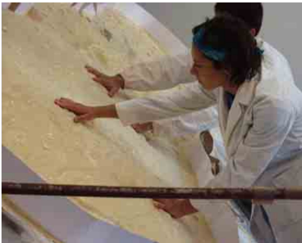
Fig. 24 – Prima della realizzazione della madreforma la superficie viene accuratamente controllata per verificare l’assenza di sottosquadri e imperfezioni.
