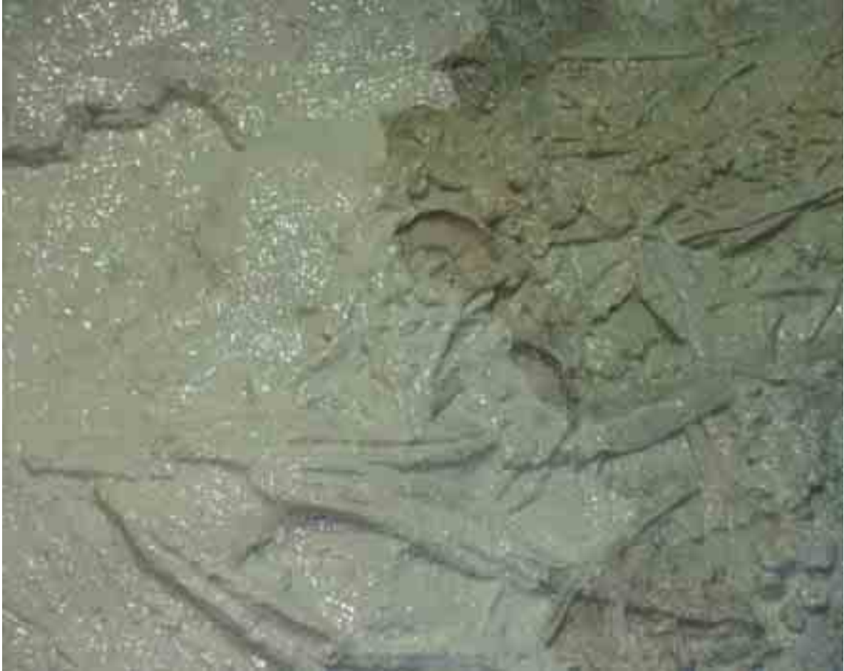
Fig. 17 – Seconda mano di elastometo siliconico con agente tixotropizzante.
