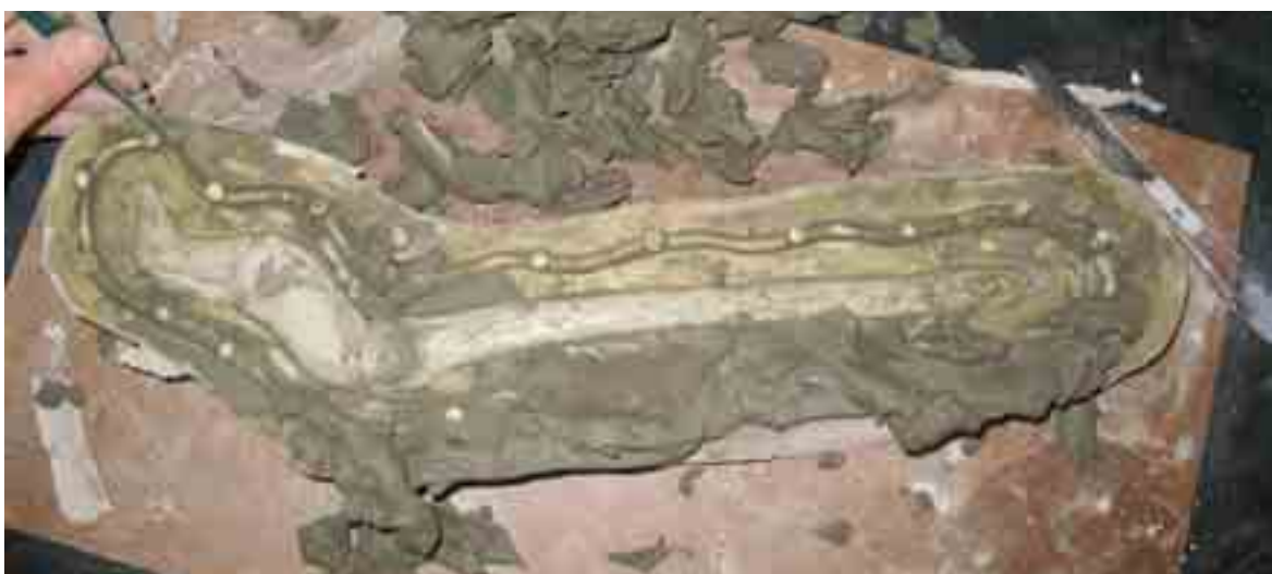
Fig. 70 – Viene tolta l'argilla dal propulsore.
