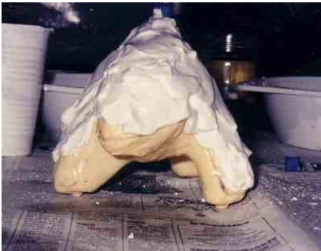
Fig. 57 – Realizzazione della prima parte della madreforma in gesso.
