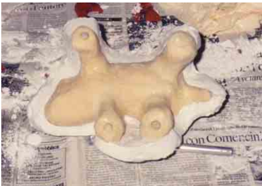
Fig. 58 – Rifinitura della prima parte della madreforma in gesso.
