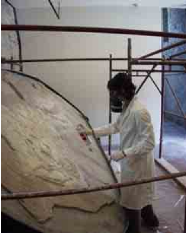
Fig. 15 – Sulla lastra viene passato il distaccante.
