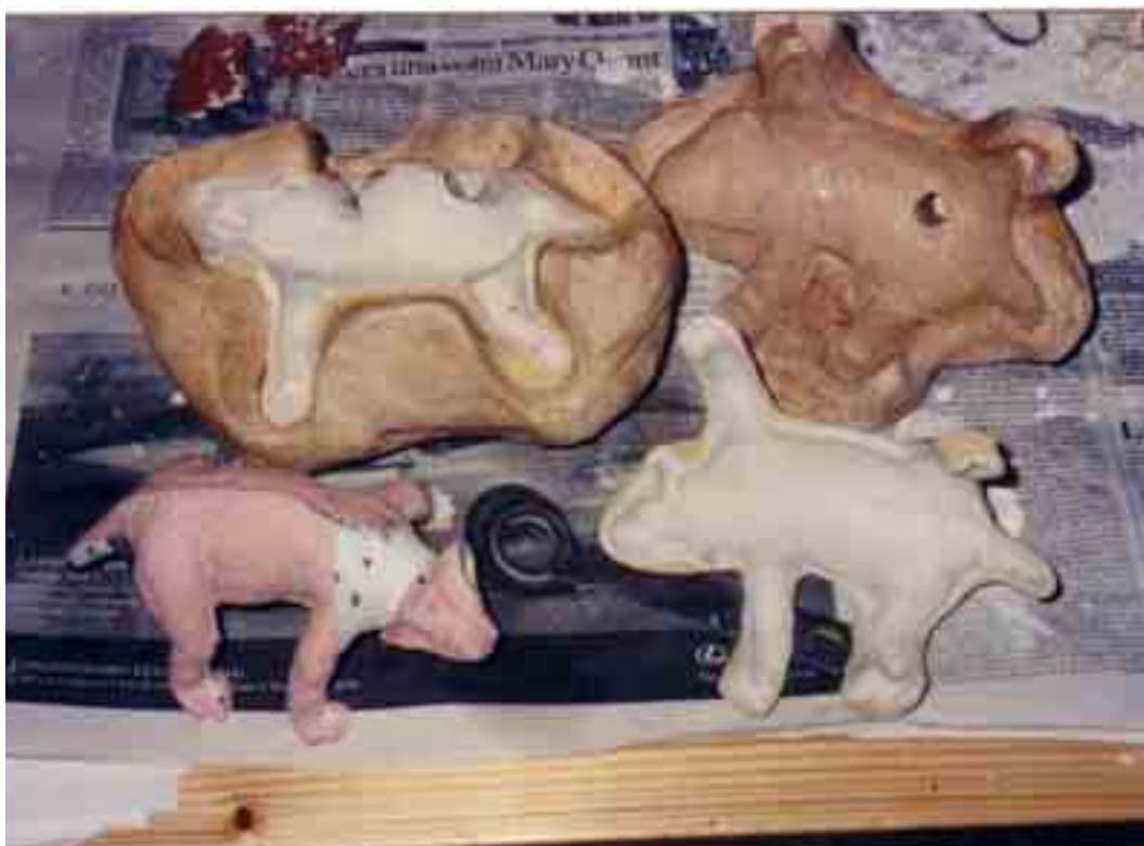
Fig. 63 – Aperta la madreforma viene liberato il prototipo dal negativo con l'aiuto di un bisturi.
