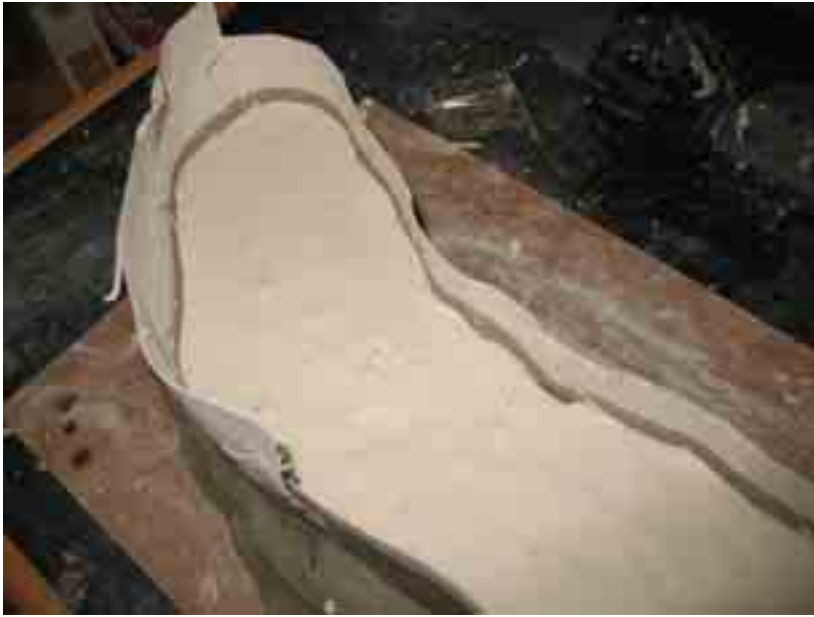
Fig. 73 – Seconda metà della madreforma e struttura di contenimento in cartone.
