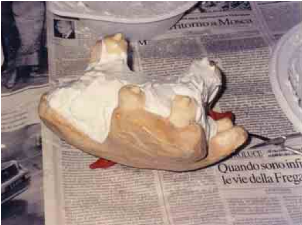
Fig. 59 – Realizzazione della seconda parte della madreforma in gesso. La prima parte è stata rinforzata con consolidante e trattata con distaccante.
