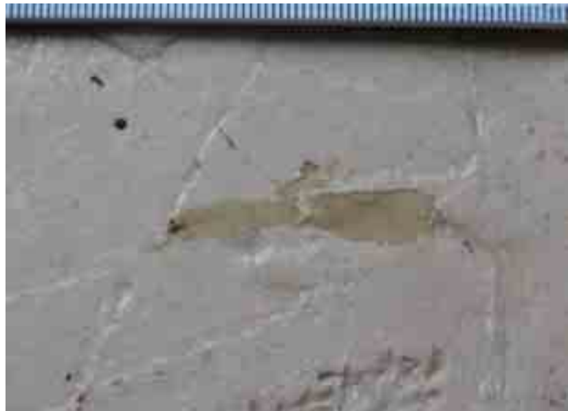
Fig 88 – Impronta, sul silicone, di una frattura dell'originale stuccata con argilla.
