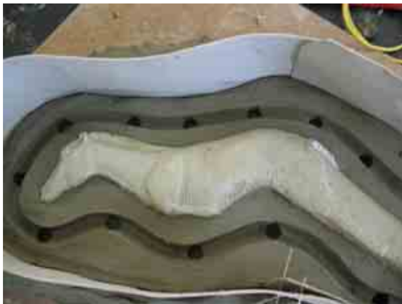
Fig. 68 – Il propulsore pronto per la realizzazione della prima parte del negativo.
