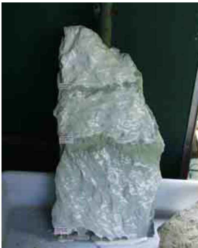
Fig. 13 – L’elastomero siliconico viene testato su un campione di roccia preso nello stesso luogo del ritrovamento dell’Ittiosauro di Genga.
