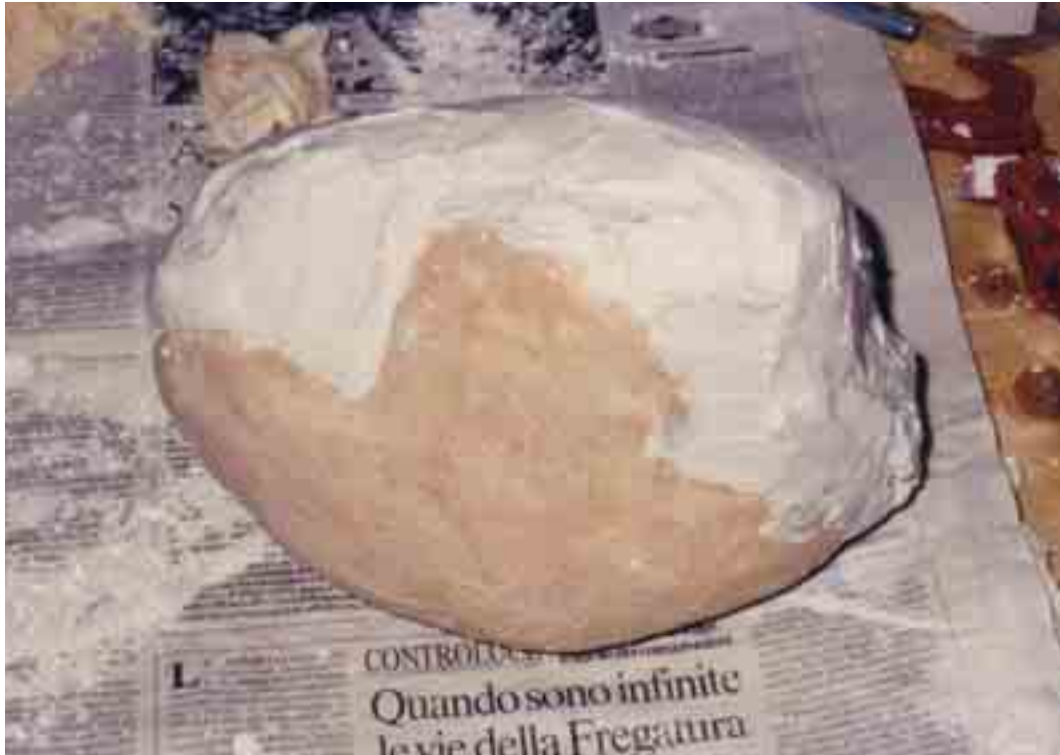
Fig. 60 – Rifinitura della seconda parte della madreforma in gesso.
