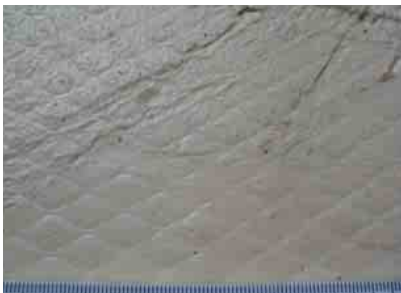
Fig. 93 – deformazione della superficie del negativo.
