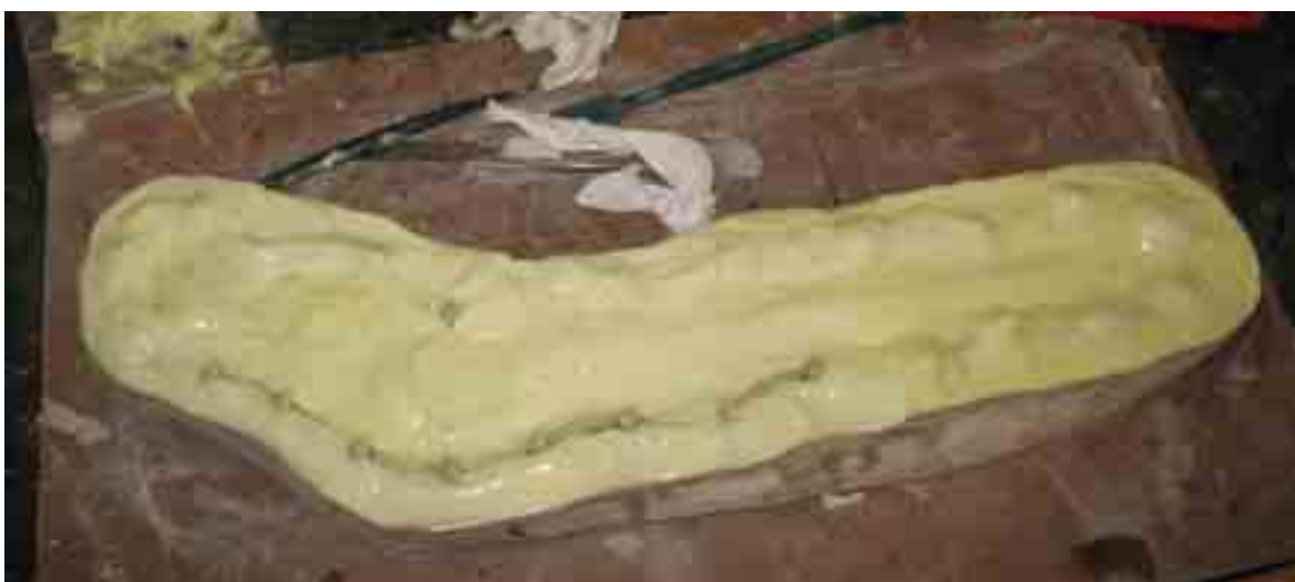
Fig. 72 – Realizzazione della seconda metà del negativo con gomma siliconica in pasta.
