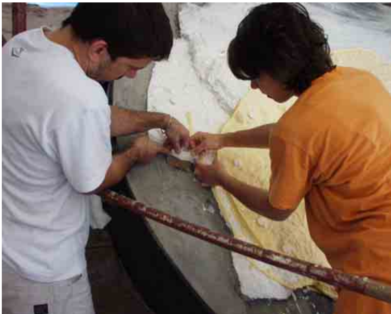
Fig. 30 – Il negativo viene staccato con cura dall’originale.
