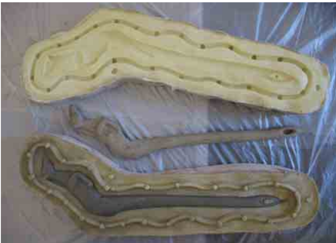
Fig. 76 – Il propulsore e il suo calco in resina ancora da sformare.
