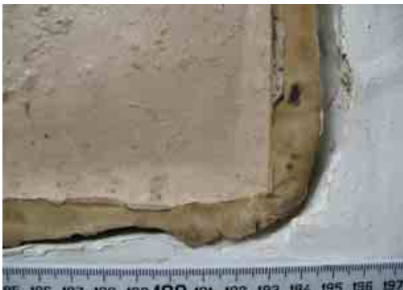
Fig 89 – Negativo, in gomma siliconica, e madreforma, in gesso. Lo spazio tra il negativo e la madreforma si è venuto a creare a causa del raccorciamento del primo.
