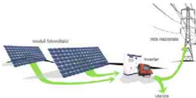
Figura 16 – Schema di un impianto fotovoltaico connesso alla rete (grid connected)
