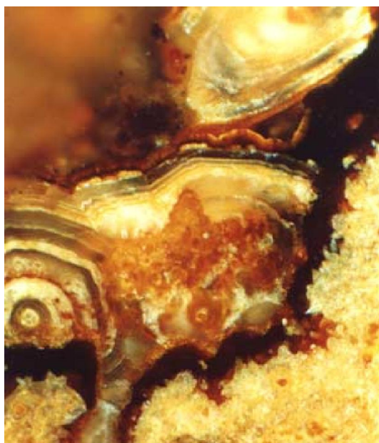
Figura 4: aggregato microcristallino (giallo) e globuli a struttura concentrica di smithsonite. ( www.econmetal.org )
