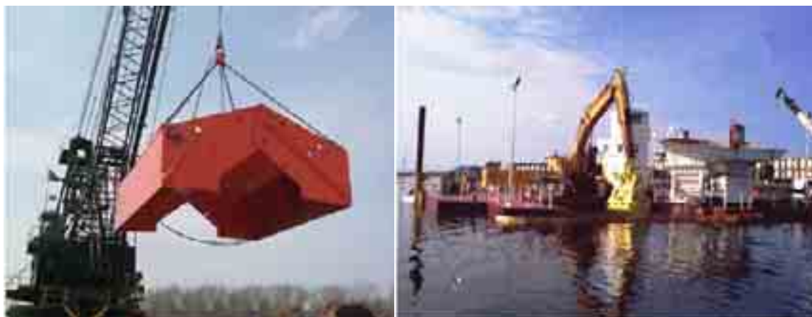
Figura 13.4- A sinistra draga a benna a tenuta stagna e a destra draga a benna con braccio articolato (da Contaminated sediments guidance for hazardous waste sites – EPA-540-R-05-012 OSWER 9355.0-85 December 2005 – www.epa.gov ).
