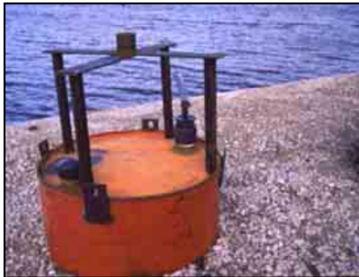
Figura 12.25- Strumento per la misura della filtrazione all'interno del sedimento.
