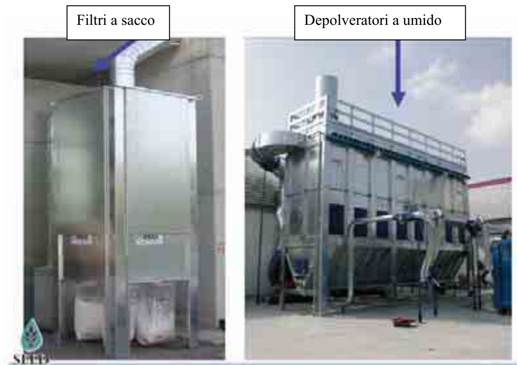
Figura 14.12 - Filtri a sacco e depolveratori a umido (da Trattamenti chimico-fisici dei sedimenti contaminati – lez.16 – Prof. Ing. Rodolfo M. A. - www.campusuniparthenope.it ).
