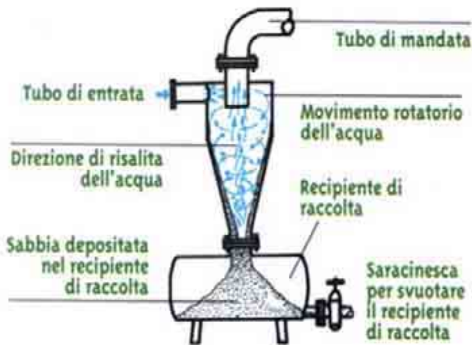
Figura 14.4- Griglia semplice, vaglio vibrante, vaglio rotante a coclea e idrociclone per la classificazione dimensionale dei sedimenti (da Trattamenti ex-situ: Dragaggio – Pre-trattamenti (cap. 9) – di Rodolfo M. A. Napoli e al. – www.campusuniparthenope.it ).
