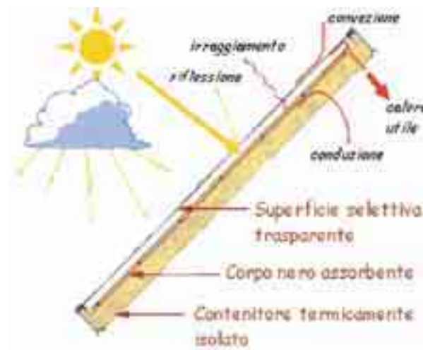
Figura 3: Schema di un collettore piano
