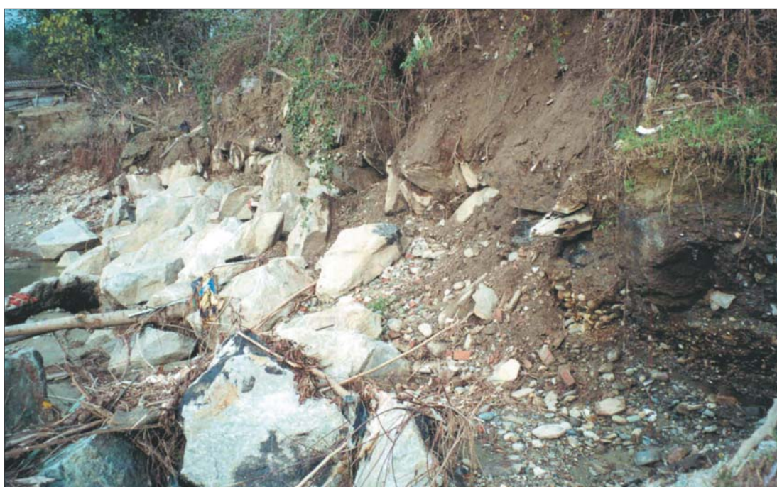
Foto 6-2: Erosione della sponda sinistra sottostante la strada d'accesso alla discarica AMIAT. Particolare della scarpata erosa e della scogliera distrutta della foto precedente. In primo piano si notano, nello strato di terreno alluvionale esposto, livelli contaminati di colore nerastro.
