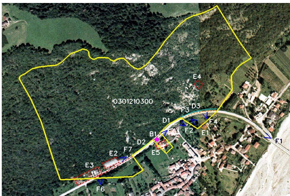
Figura 11.20 Fenomeno franoso n. 0300330300 riportato su ortofoto a colori. Area soggetta a crolli/ribaltamenti diffusi in Comune di Tolmezzo (Udine), rilevata ai fini della redazione del Piano Stralcio per l'Assetto Idrogeologico. Sono evidenziati gli elementi a rischio (E1-E3), le opere di difesa (D1- D2) ed i punti di vista dai quali sono state scattate le fotografie (F1-F7).
