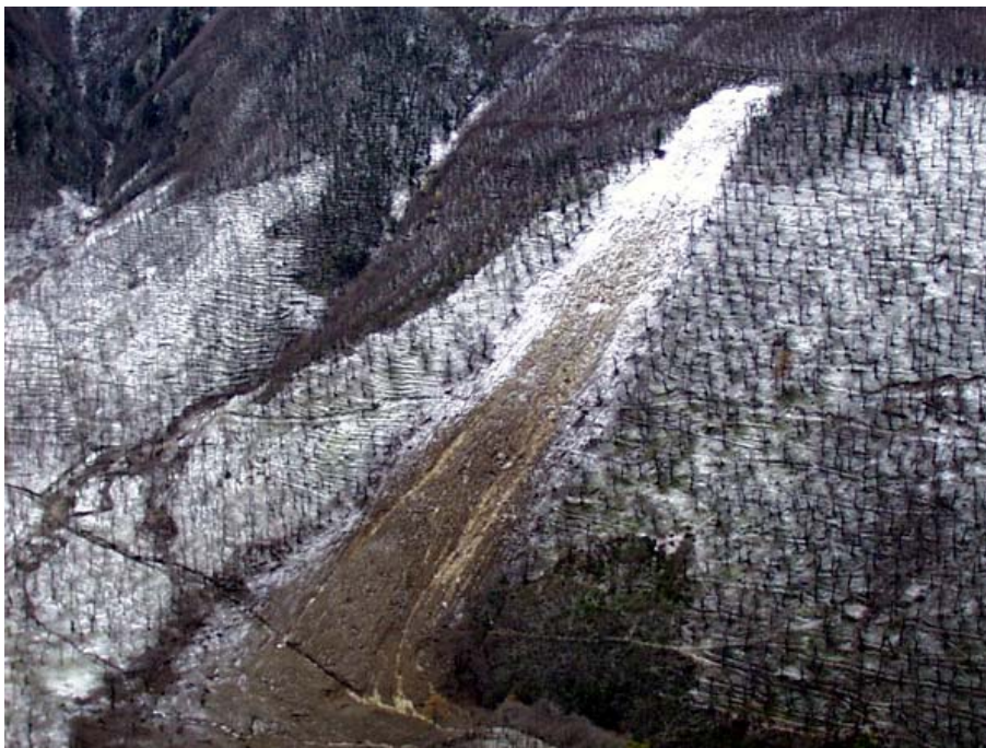
Figura 3.19 Colata rapida di fango, Cervinara (AV). Il pendio è tagliato in più punti da una strada forestale.
