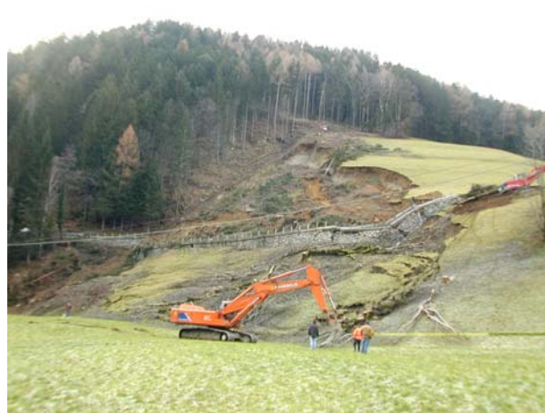
Figure 8.16 Fasi di distacco dell'evento franoso (fratture di trazione e distacco del corpo di frana).
