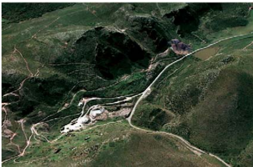
Fig. 16 - Il versante in secondo piano è interessato dallo sfruttamento del cantiere di Acquaresi. Sono evidenti gli importanti interventi antropici e le tracce delle subsidenze allineate lungo il giacimento Marx.
