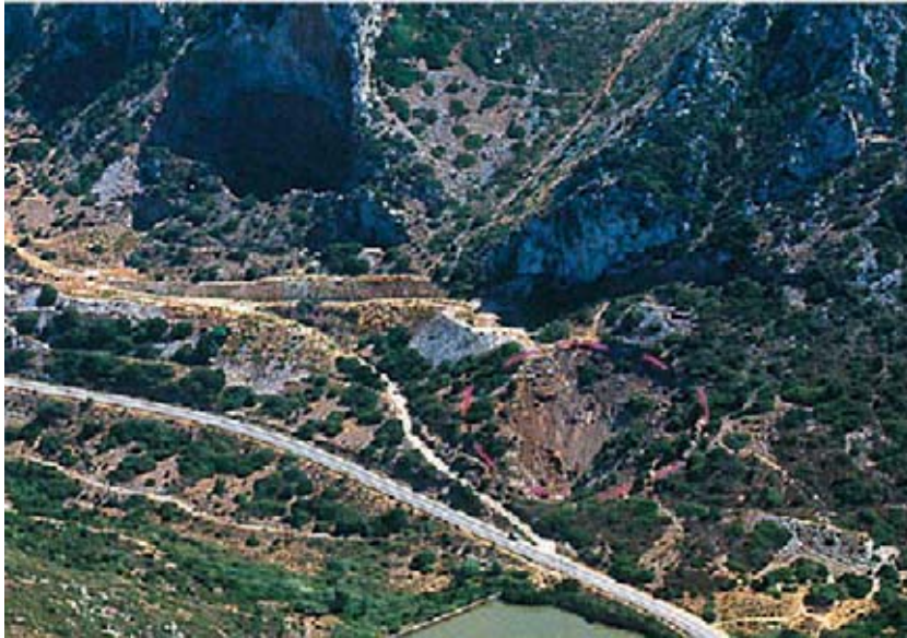
Fig 7 - L'inghiottitoio formatosi è di forma ellittica, con l'asse maggiore di oltre 100 metri e il minore di circa 70
