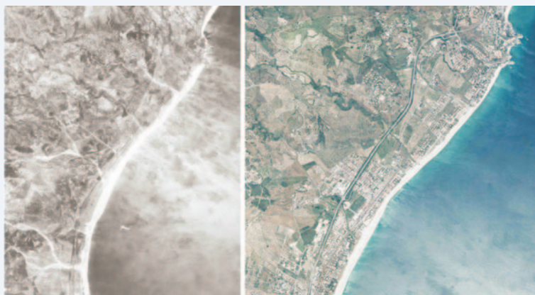
Fig. 4.40 - Confronto tra le foto aeree del 1955 (sinistra) e 1990 (destra) di un'area del Catanzarese. Si noti il forte incremento delle aree impermeabilizzate (urbano+infrastrutture).
