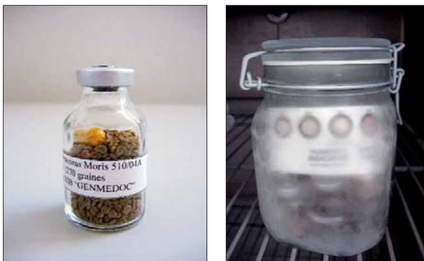
Figura 26 - Vials in vetro con chiusura a pressione in uso presso BG-SAR al cui interno, per monitorare il contenuto di umidità, sono state inserite due capsule trasparenti in gelatina con gel di silice microgranulare e barattolo in vetro chiuso a pressione con una etichetta cartacea per il monitoraggio dell'umidità. (foto: E. Mattana)
