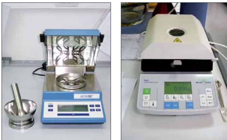
Figura 20 – Esempi di analizzatori elettronici di umidità o termobalance, in uso presso la Banca del Germoplasma della Sardegna (BG-SAR) e al Banc de Llavors Forestals (CIEF). (foto: E. Mattana)
