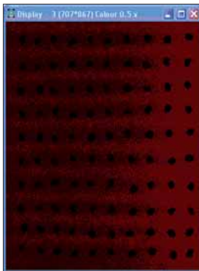
Figura 52 - Immagine contrastata. Serve a delineare con chiarezza il contorno degli oggetti che dovranno essere misurati. (foto: G. Venora)
