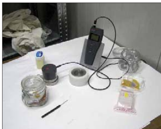
Figura 23 – Strumentazione per la misura dell'attività dell'acqua ( a_w ) in uso presso il M.A.I.Ch. (Creta). (foto: G. Bacchetta)
