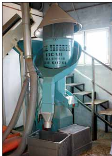
Figura 19 – Macchina a flusso d'aria per la pulizia di grandi lotti di semi in uso presso il Blanc de Llavors Forestals (CIEF). (foto: A. Prada)
