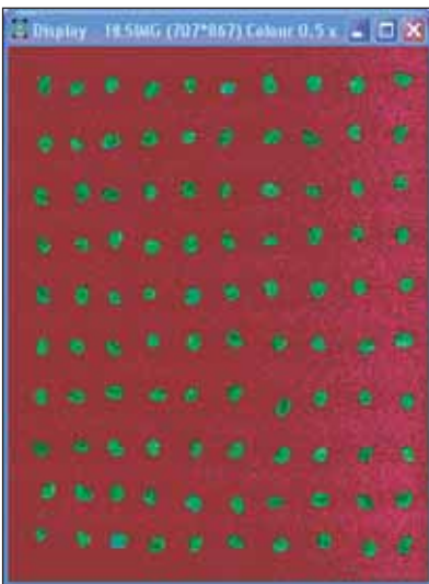
Figura 54 - Immagine in HLS. Creata dall’immagine standardizzata per convertire i colori dal modello RGB (Red, Green, Blue) al modello HLS (Hue, Lightness, Saturation) in modo da ottenere un’immagine sulla quale è possibile misurare altri tre parametri colorimetrici. (foto: G. Venora)
