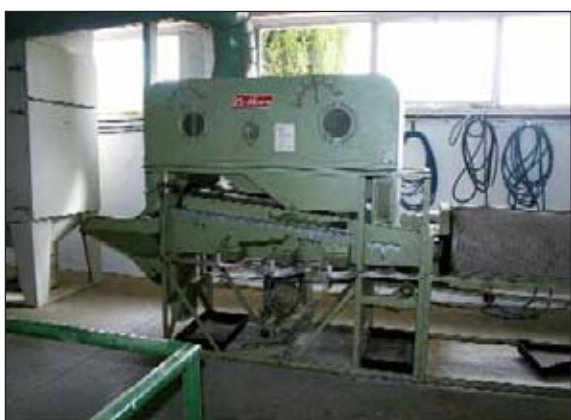
Figura 18 - Macchina a flusso d'aria e con cilindro dentato per la separazione dei semi del CNGF El Serranillo. (foto: A. Prada)
