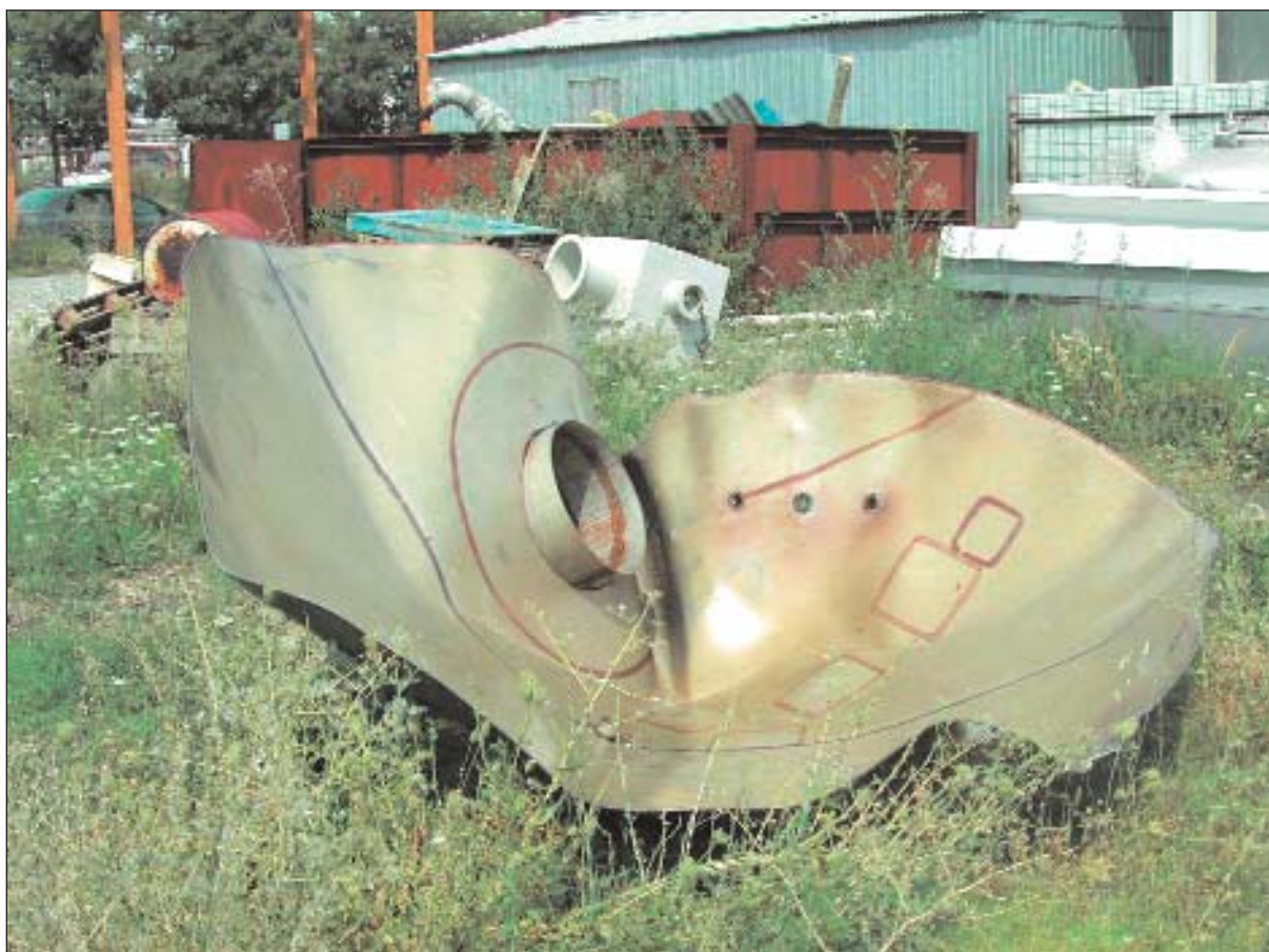
Figura IX.8 – Tetto del serbatoio proiettato dall'esplosione.
