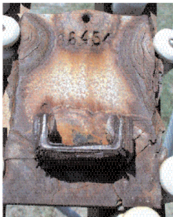
Figura IX.15 – Prove di corrosione: effetti provocati su provini saldati (immagine in alto) da corrosione intergranulare per esposizione ad ambiente costiero marino (immagini in basso).
