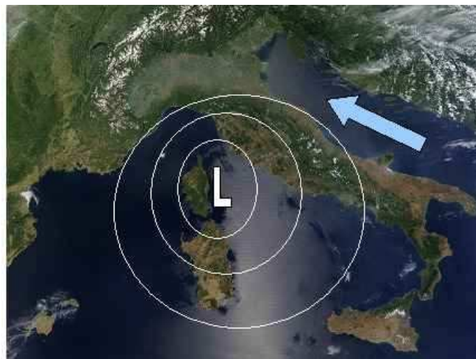
Figura 4: Schema tipo di depressione atmosferica che può causare acqua alta nella Laguna di Venezia.
