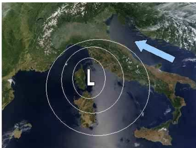
Fig. 4 Schema tipo di depressione atmosferica che può causare acqua alta nella Laguna di Venezia
