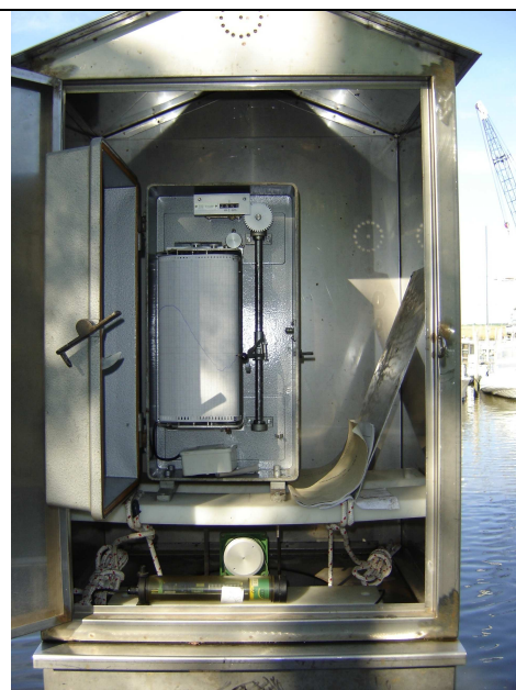
Figura 4: Cabina interna di una stazione mareografica con rullo cartaceo.
