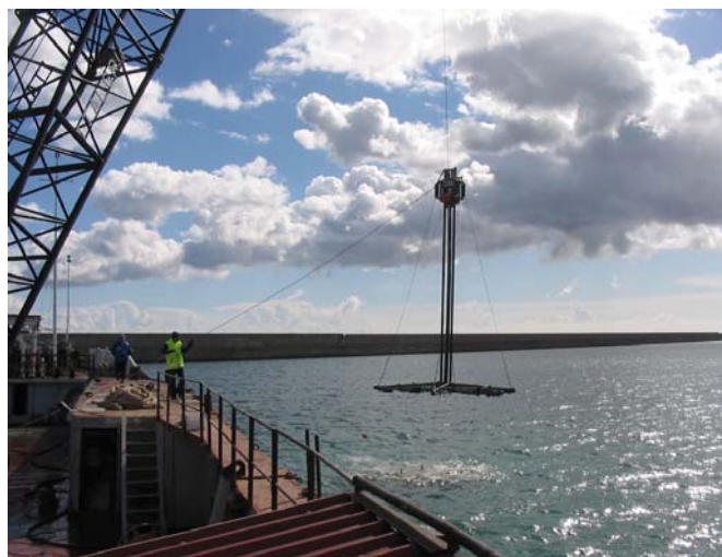
Fig. 5.3.4.1.1. Carotatore utilizzato per il campionamento nel Porto di Gioia Tauro.
