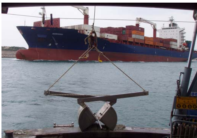
Fig. 5.3.4.2.2. Benna utilizzata per il campionamento nel porto di Gioia Tauro.
