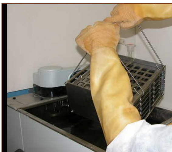
Figura 4.4 introduzione dell'apposito rack con 6 telai all'interno della soluzione a 98°C della soluzione a 90°C
