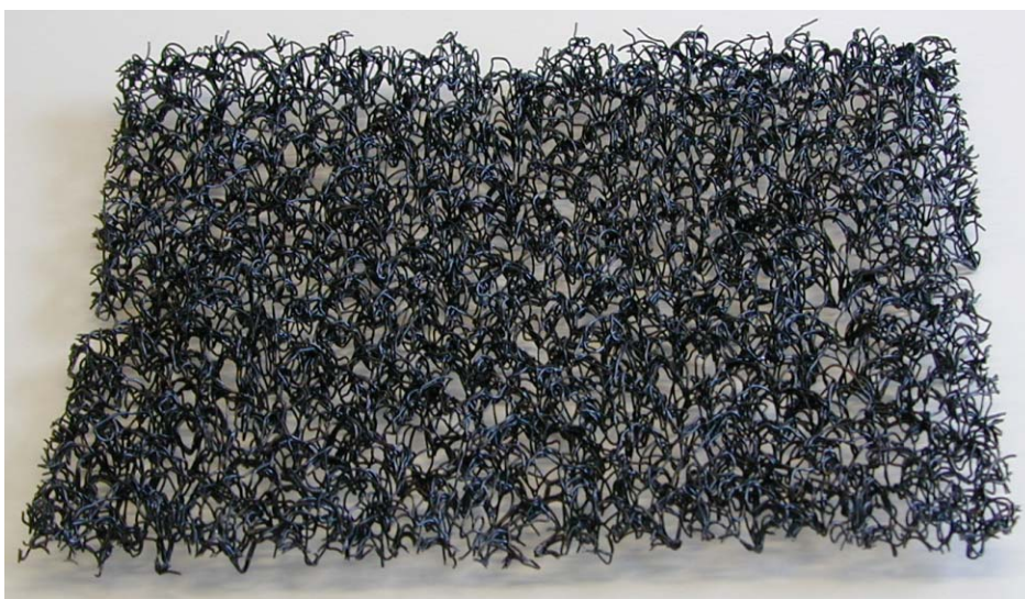
Esempio di struttura di geostuoia
