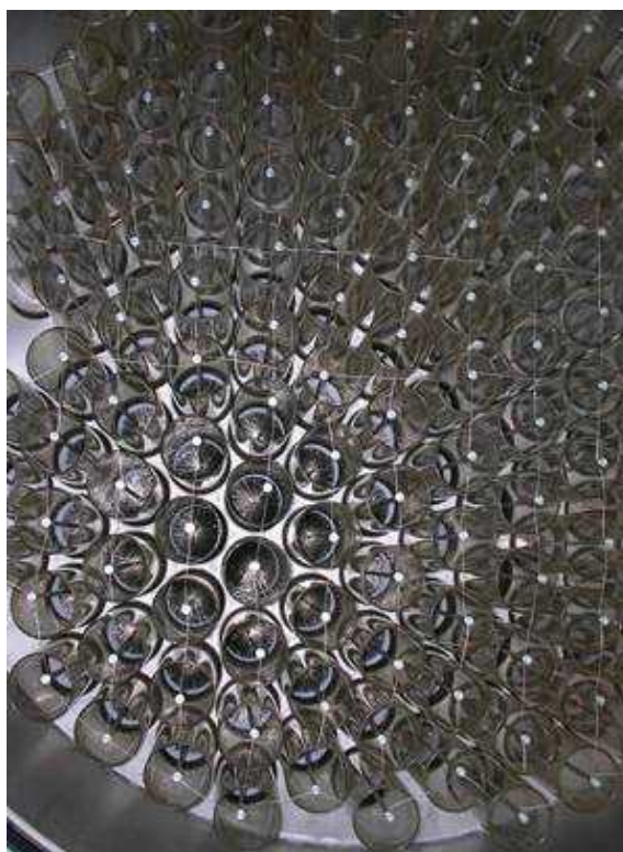
Foto 2.6 – Camera di produzione Ozono
