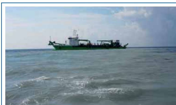
Figura 9.3: Plume di torbida superficiale generata dalle attività di dragaggio (overflow) 8
