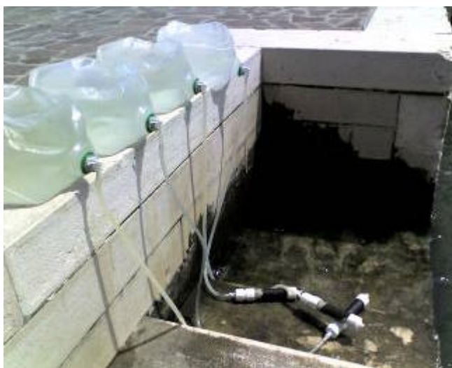
Figura 5: passaggio dell'acqua prelevata attraverso le fibre di \text{MnO}_2 (fonte: foto Claudio Cabianca)
