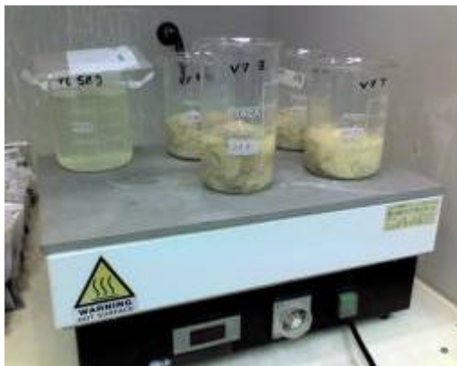
Figura 7: i campioni di fibra immersi nella miscela e posti su piastra per lo schiarimento (fonte: foto Claudio Cabianca)
