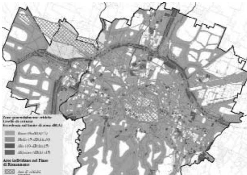
Figura 2 – Mappatura delle criticità acustiche della città di Bologna (2° Rapporto dello Stato dell'Ambiente Comunale, 2002)
