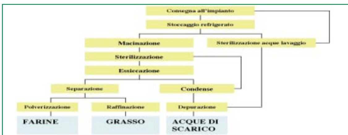
Figura 6.9: Schema del processo per l'ottenimento delle farine d'ossa
