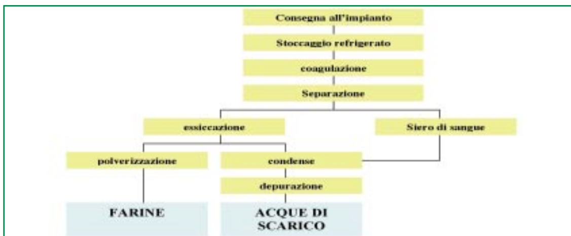
Figura 6.10: Schema del processo per l'ottenimento del sangue
