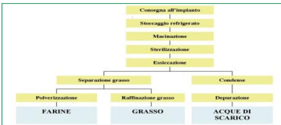
Figura 6.9: Schema del processo per l'ottenimento delle farine d'ossa
