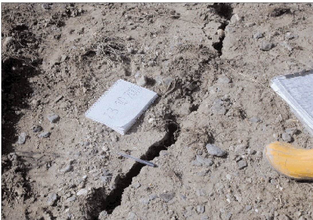
Figura 3.3: Una frattura di trazione nei pressi di Rovarey de Verres (Nus) una settimana dopo l'evento alluvionale mostrava ancora un'apertura di qualche cm.
