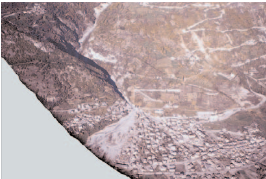
Figura 3.1: La colata rapida lungo il vallone del torrente S.Barthelemy che ha investito il centro abitato di Nus.
