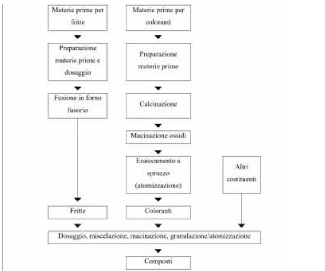
Figura 2.2.2: Cicli tecnologici per la produzione di fritte e prodotti per smalti - Fonte: Assopiastrelle.
