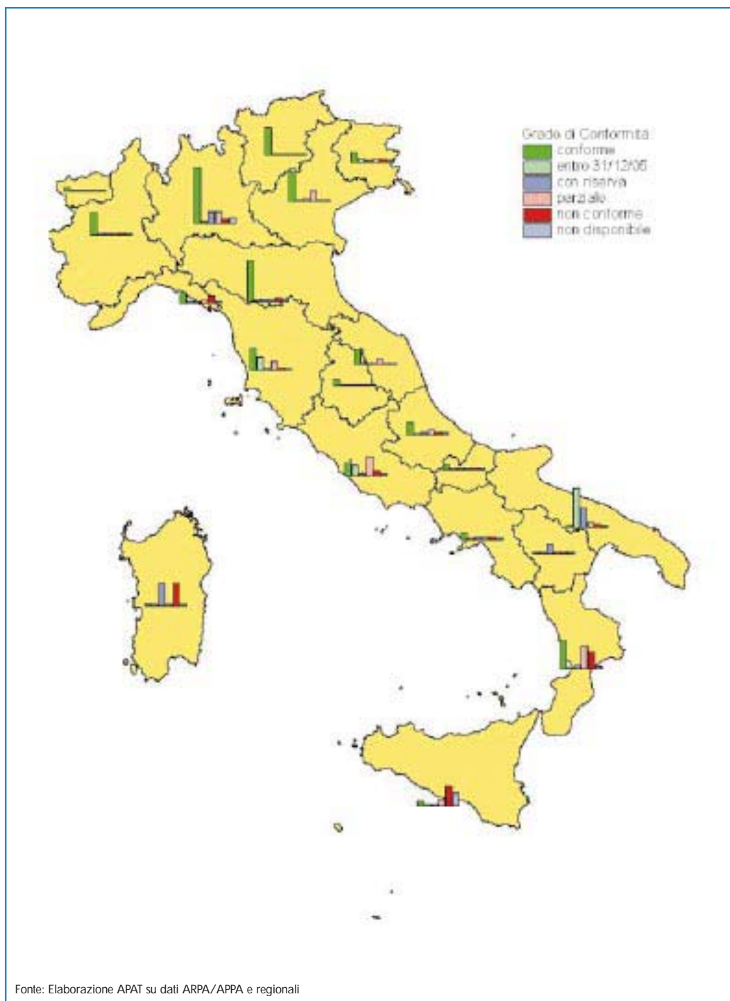
Figura 3.26: Grado di conformità del sistema di depurazione per gli agglomerati > 15.000 abitanti equivalenti
