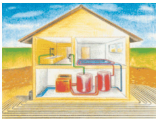
Figura 28. Esempio di applicazione geotermica per uso domestico
