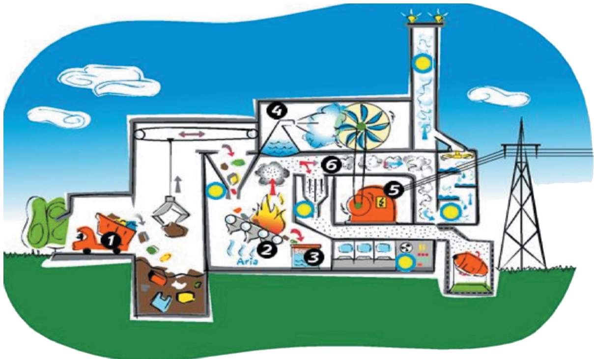
Figura 32. Schema di funzionamento di un impianto termovalorizzatore
